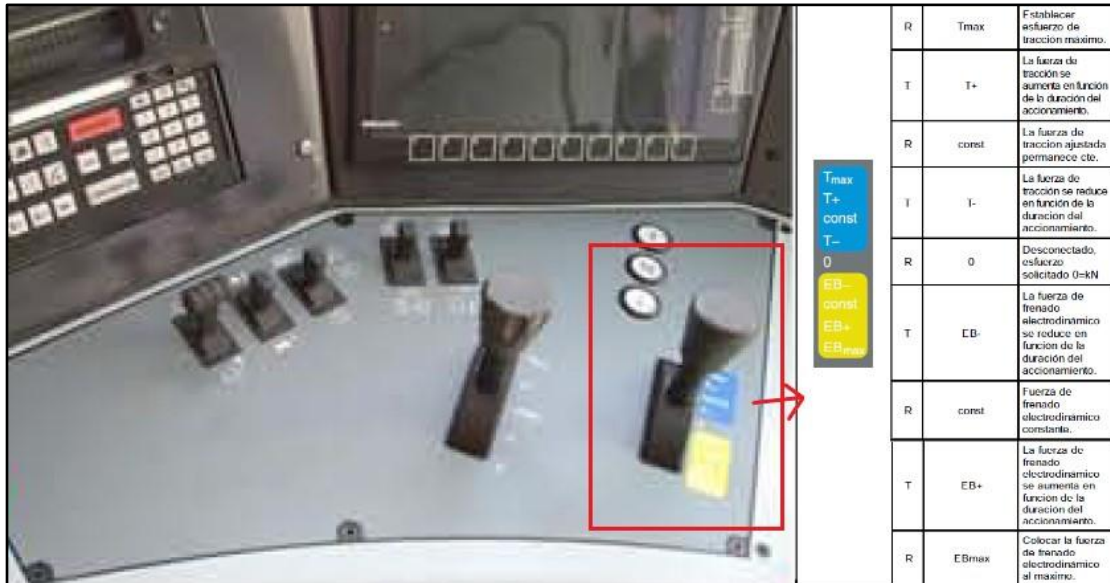
Imagen 5 Imagen del manipulador de tracción/freno eléctrico la izquierda en el pupitre de conducción.
