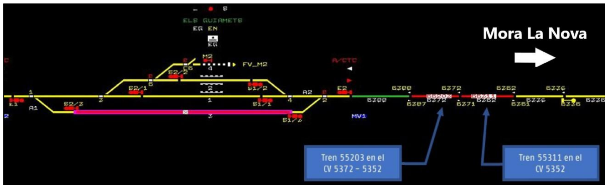
Imagen 10 Tren 55203 rebasando la señal dotada de letra P 5371 cuando el tren 55311 está detenido en el CV posterior
