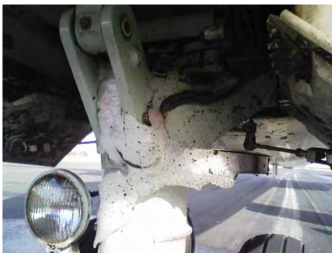
Figura 1. Fotografía del hielo alojado en el compartimento del tren de morro
