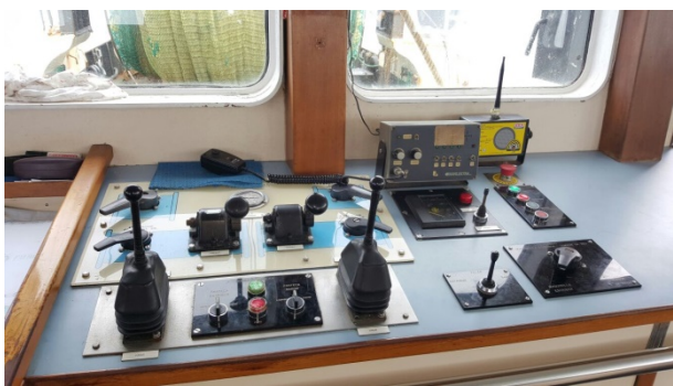
Figura 3. Mandos de la maquinilla en el puente
