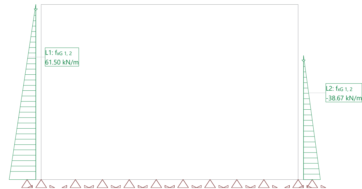
Hipótesis de carga ETC1: Empuje terreno construccion1
