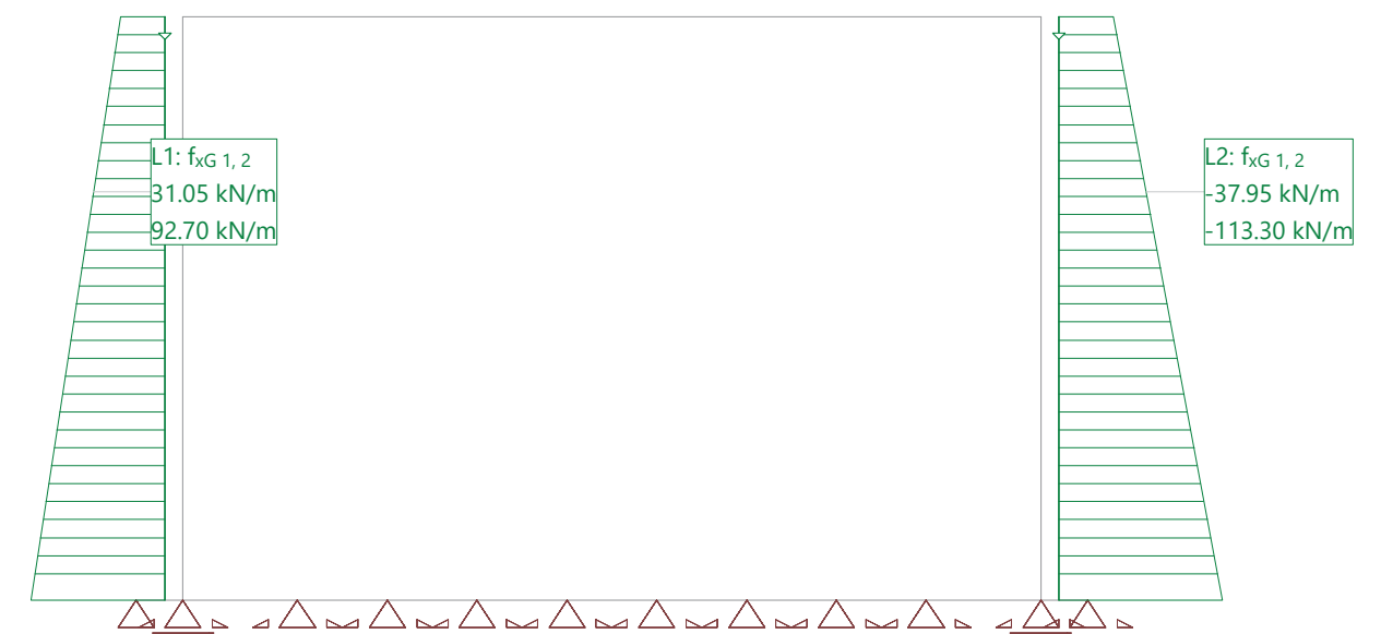
Hipótesis de carga ETR1: Empuje terreno reposo1
