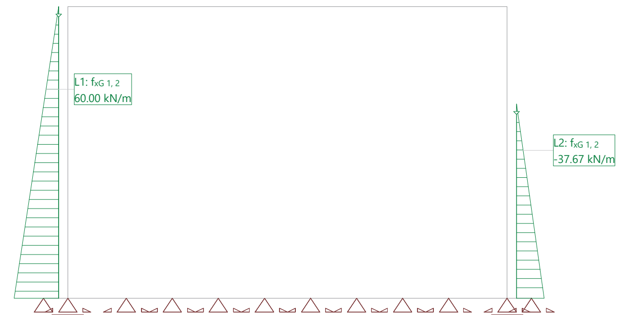
Hipótesis de carga ETC1: Empuje terreno construccion1
