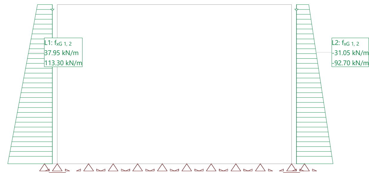
Hipótesis de carga ETR2: Empuje terreno reposo2
