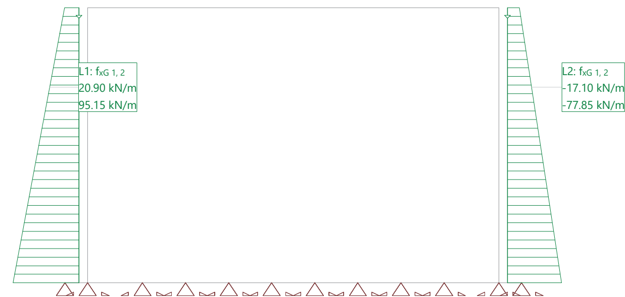
Hipótesis de carga ETR2: Empuje terreno reposo2
