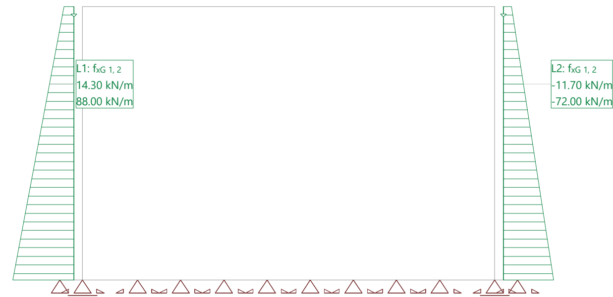
Hipótesis de carga ETR2: Empuje terreno reposo2
