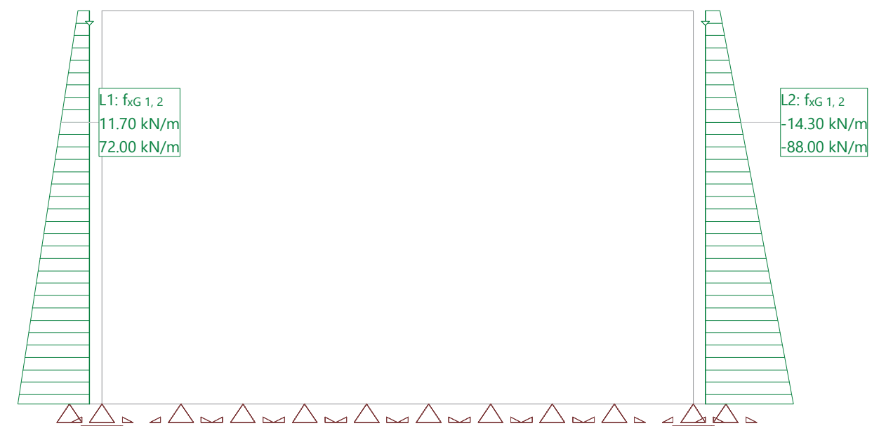
Hipótesis de carga ETR1: Empuje terreno reposo1
