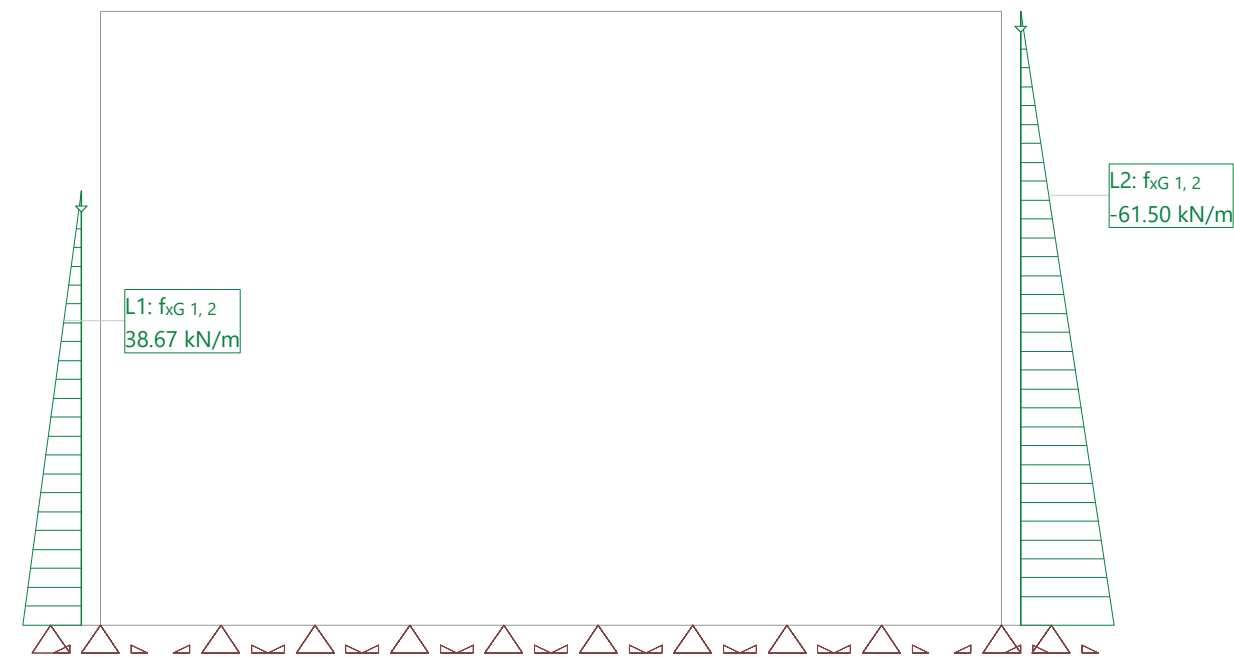
Hipótesis de carga ETC2: Empuje terreno construccion2
