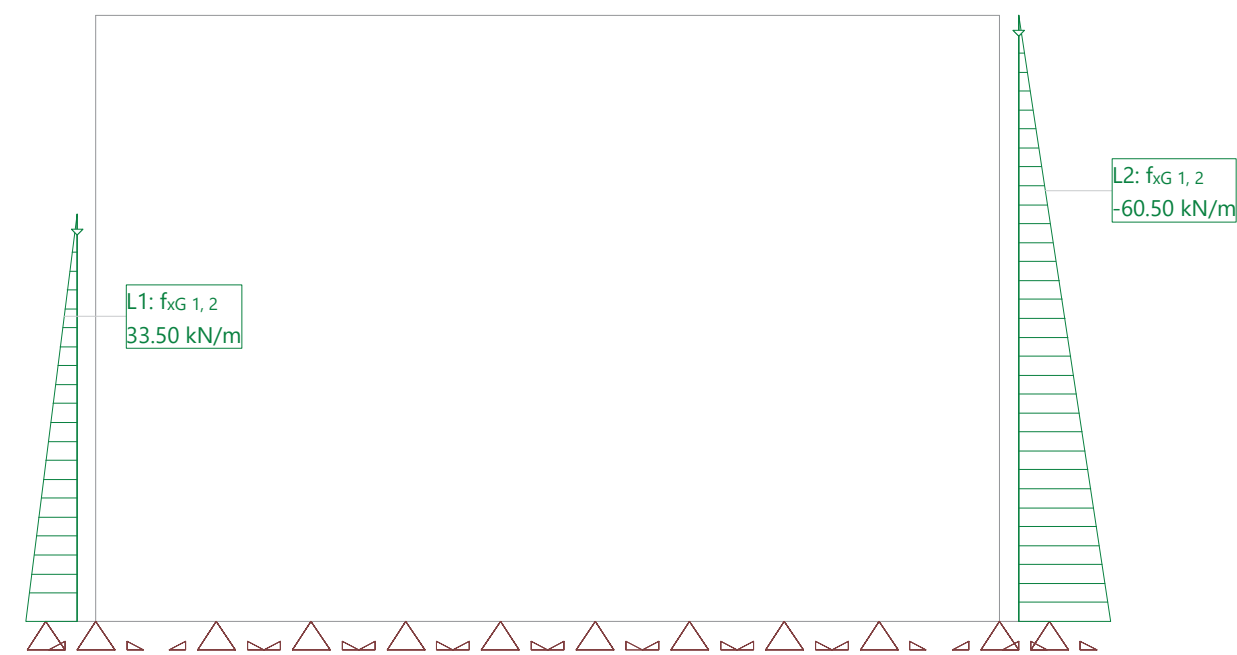
Hipótesis de carga ETC2: Empuje terreno construccion2
