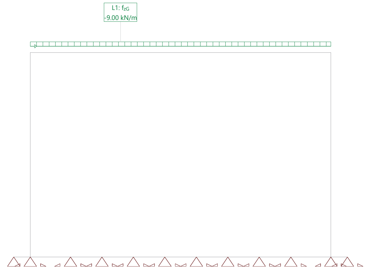
Hipótesis de carga SCU: Sobrecarga uniforme
