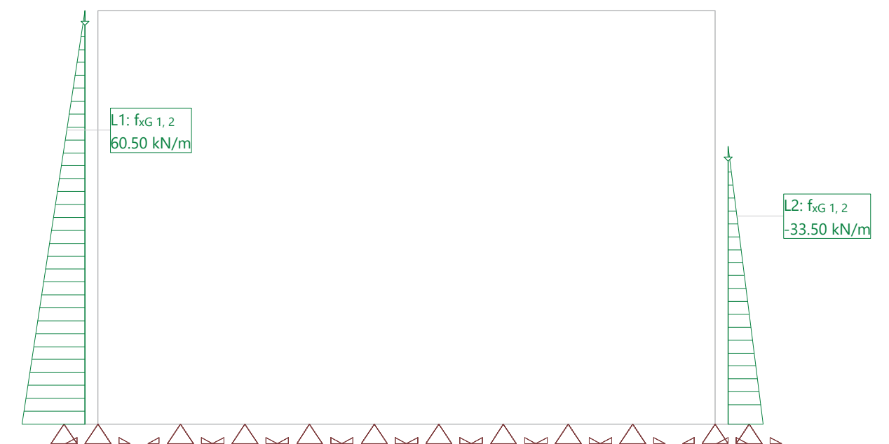
Hipótesis de carga ETC1: Empuje terreno construccion1
