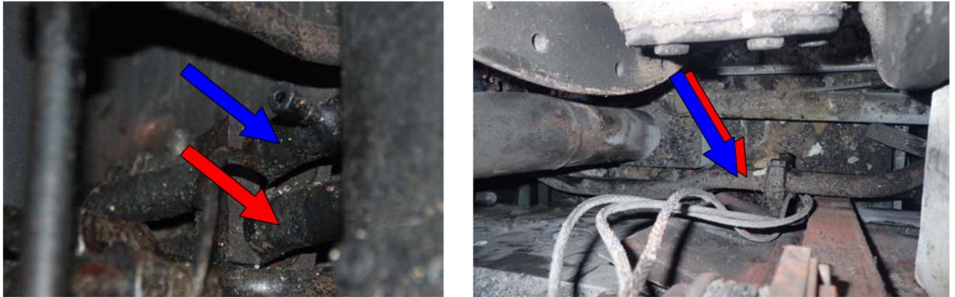
Figura 7. Líneas principales de combustible.
