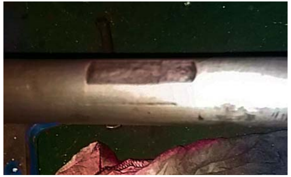
Figura 9. Desgaste encontrado en octubre de 2017.
