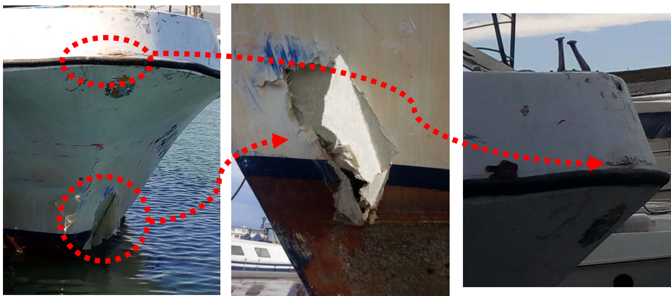
Figura 5. Daños externos sufridos por el ISLETA TERCERA
