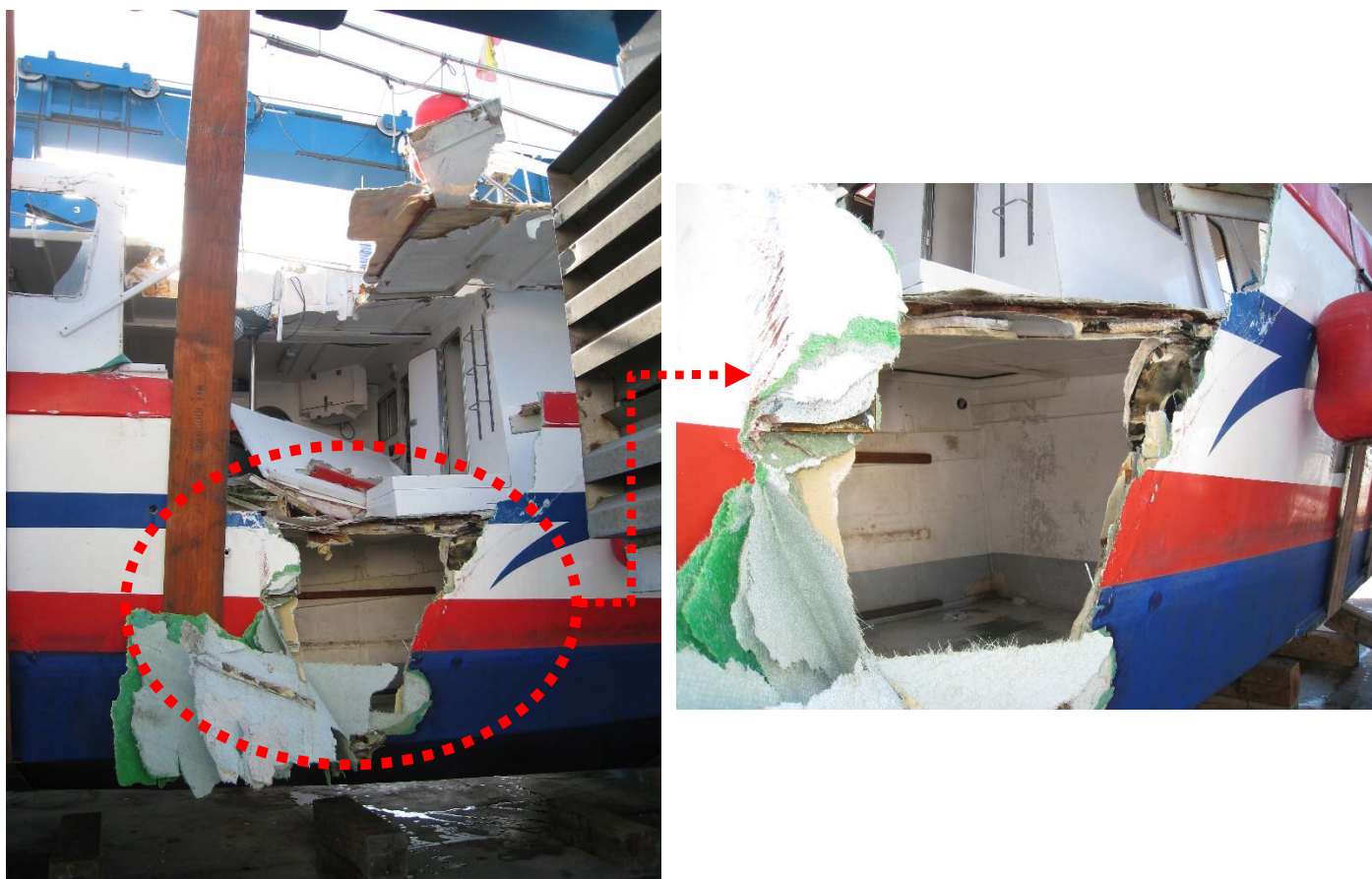
Figura 6. Daños al CATAN, costado de estribor, hacia la medianía un poco hacia popa.
