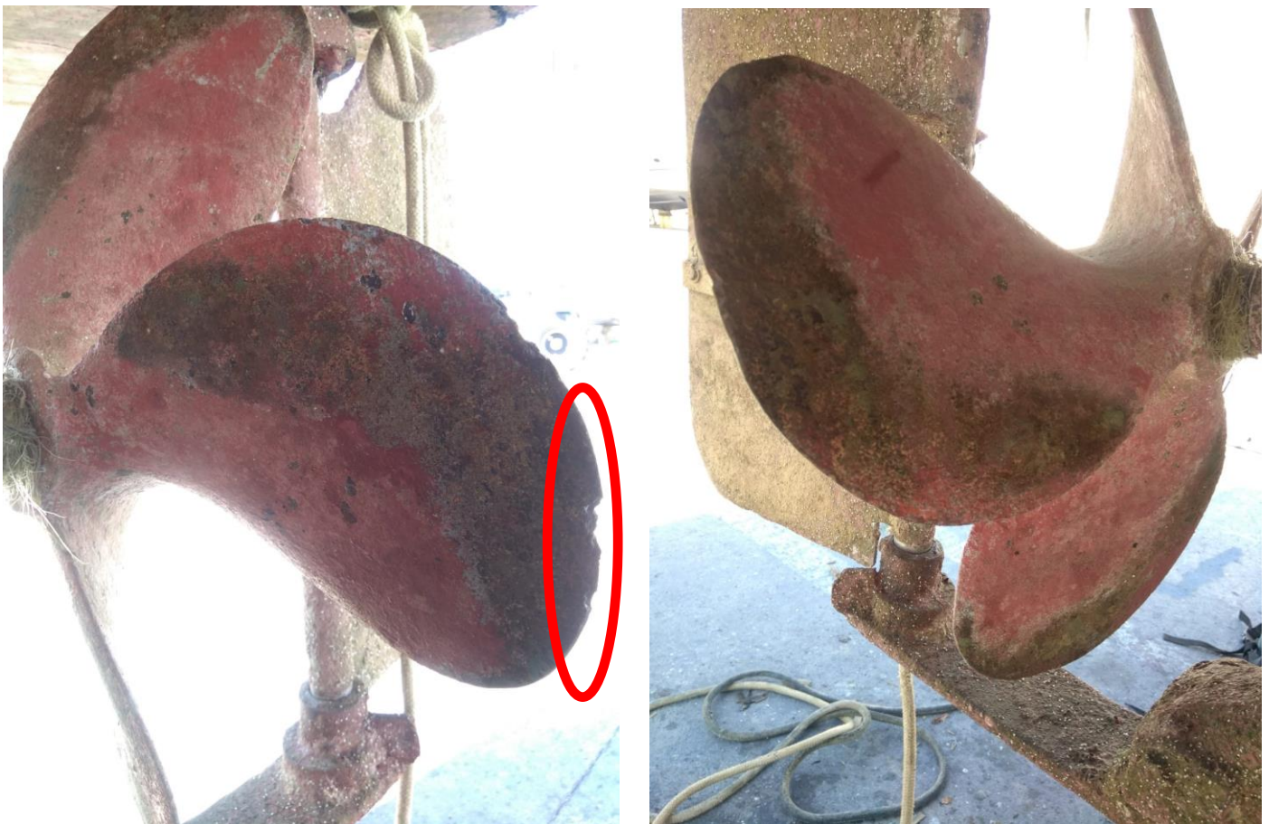
Figura 7. Mellados recientes encontrados en la hélice.
