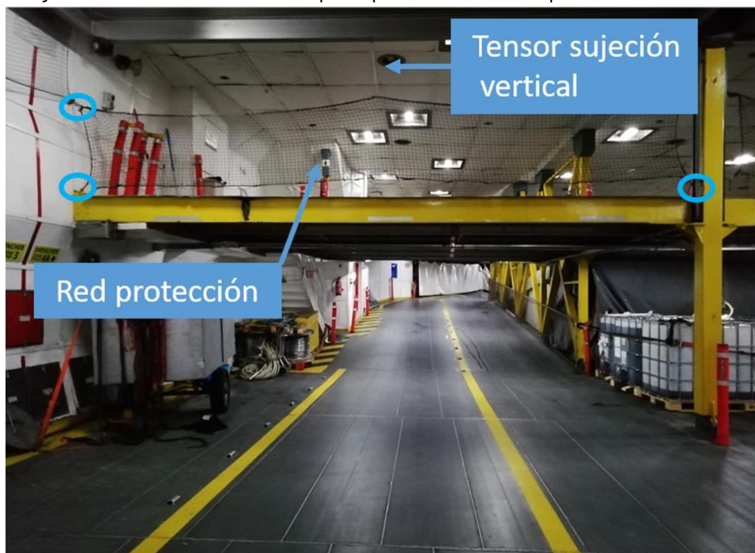
Figura 4. Cubierta elevable de vehículos equipada con redes en el VOLCAN DE TENO. Indicado en azul tres de los cuatros puntos de anclaje y el tensor de sujeción vertical.
