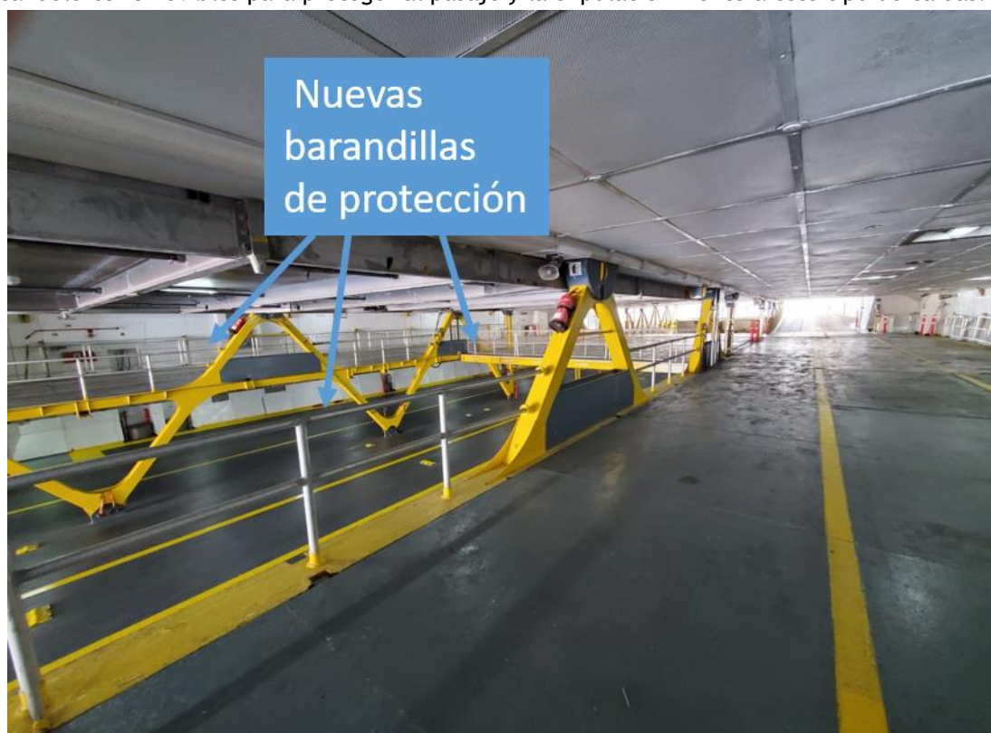
Figura 9. Cubiertas elevables de vehículos equipada con las nuevas barandillas rígidas en el VOLCAN DE TENO.
