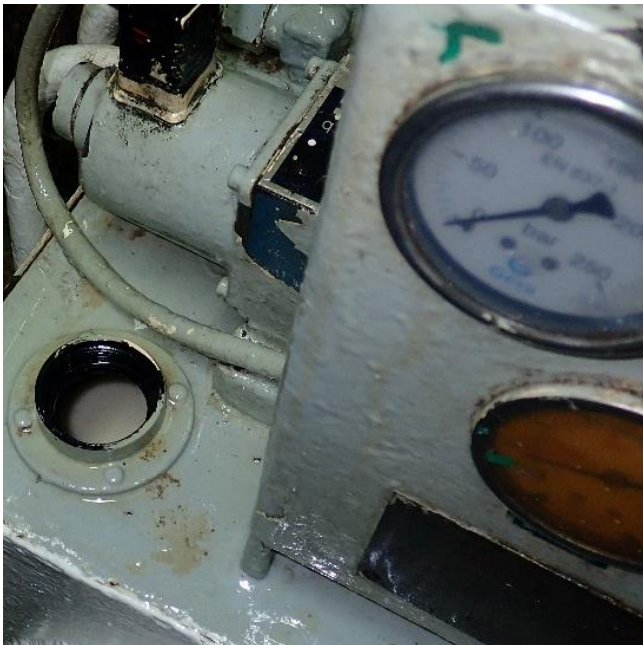
Figura 16. Aceite hidráulico burbujeante
