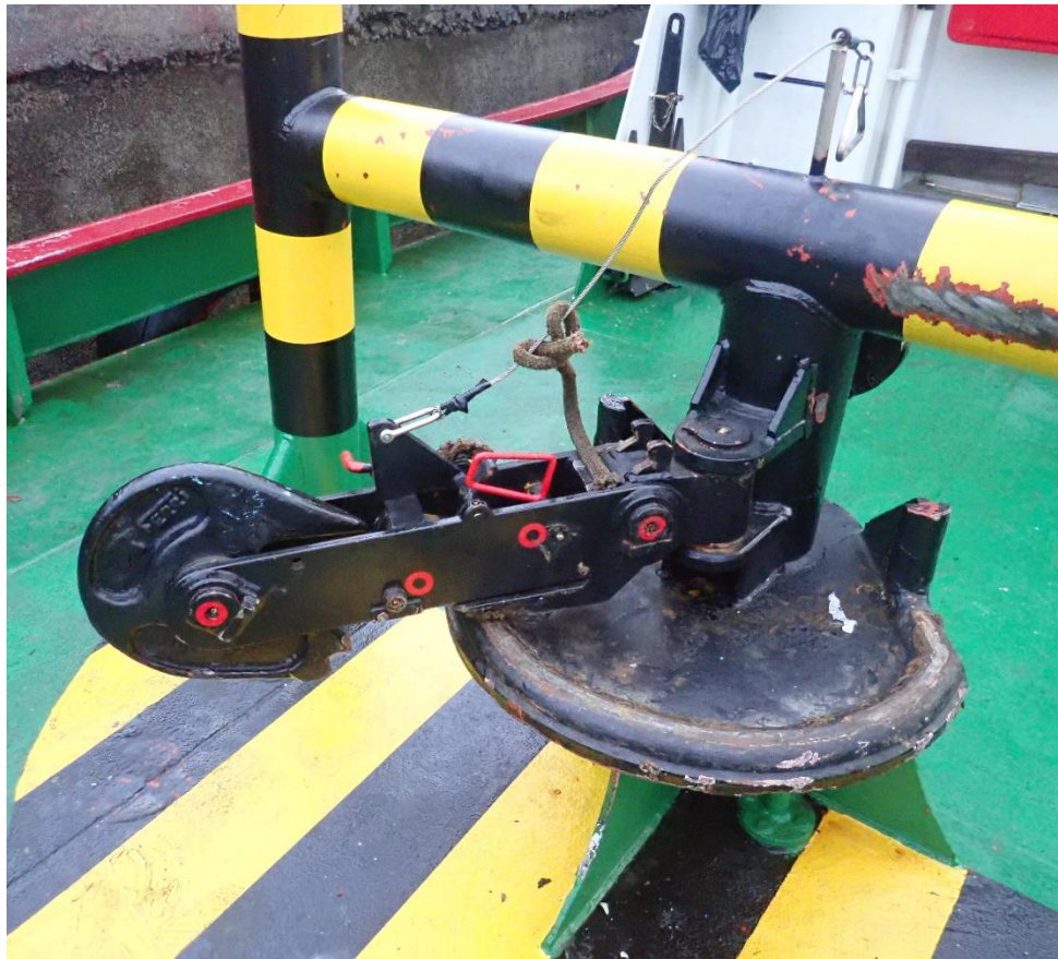
Figura 38. Gancho de remolque del GAVIOTA
