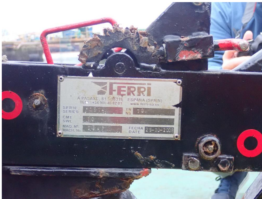
Figura 39. Placa identificativa y grasa en el gancho de remolque del GAVIOTA
