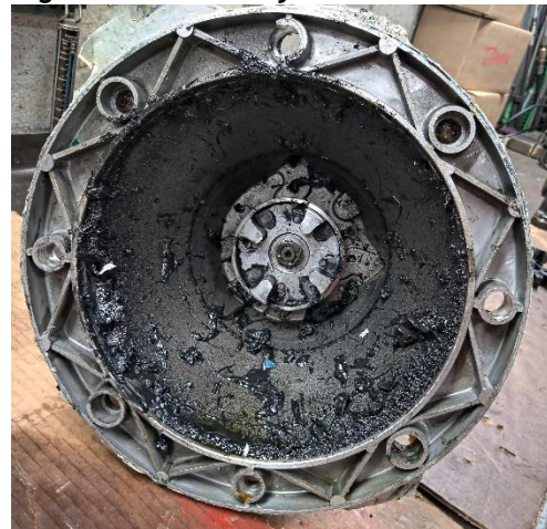
Figura 31. Campana de adaptación de la bomba número 2
