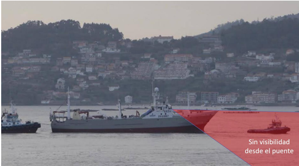
Figura 43. Visibilidad desde el puente durante la maniobra de remolque (fotografía posterior al accidente, el remolcador a proa es el JOSITA C)
