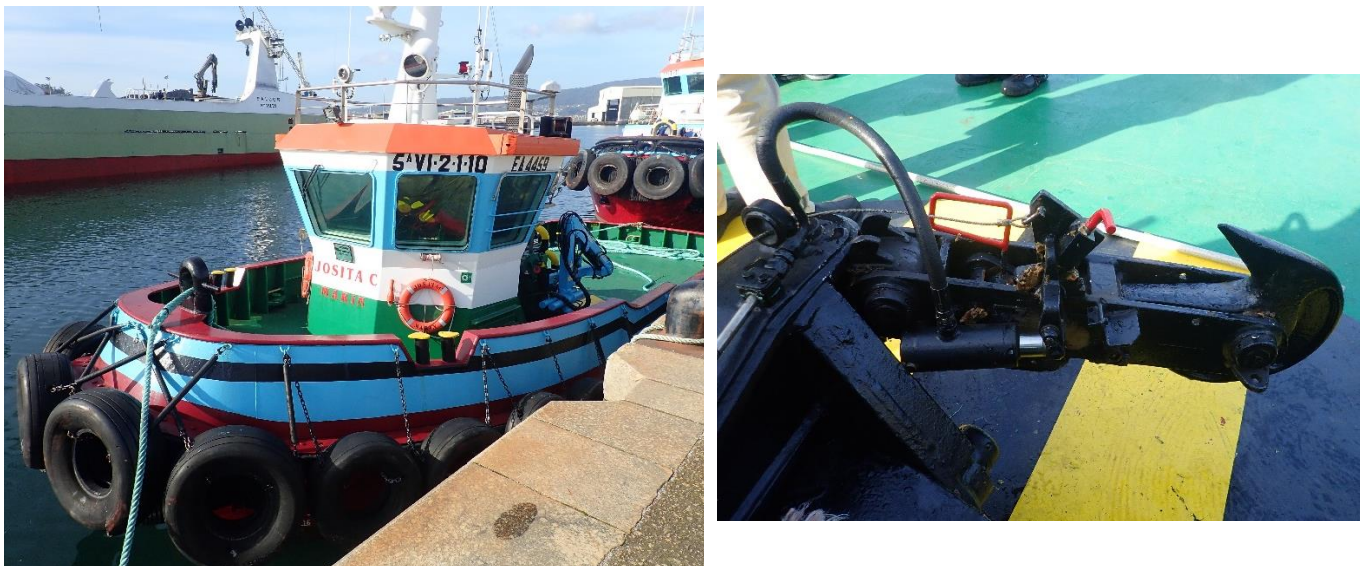
Figura 44. JOSITA C y su gancho con sistema hidráulico de disparo desde el puente.
