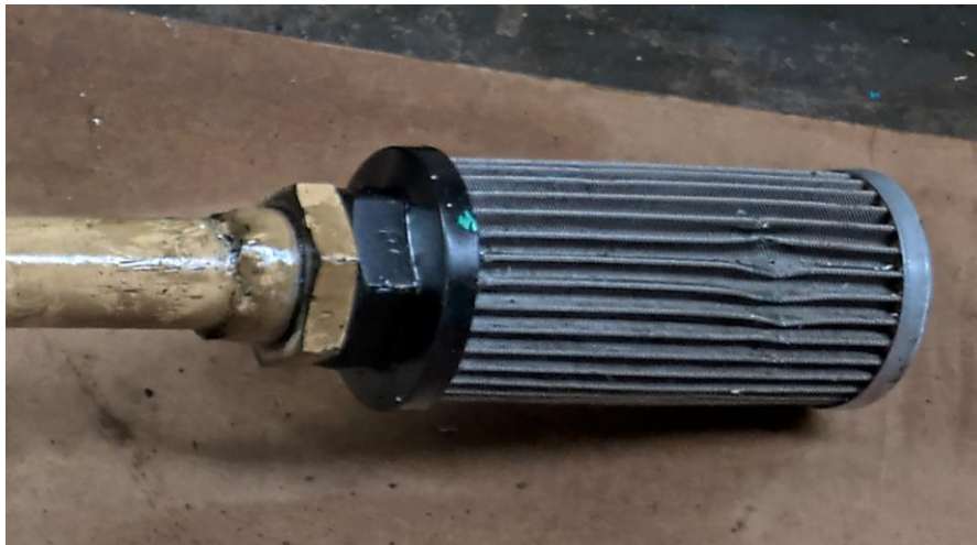
Figura 25. Detalle del filtro de aspiración de aceite de la bomba número 2
