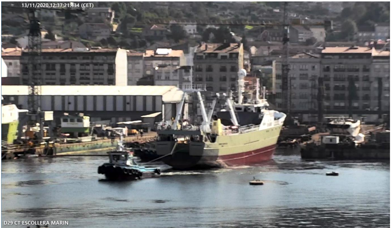
Figura 47. Salida del HERMANOS GANDON CUATRO del varadero, JOSITA C tirando por la popa
