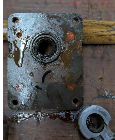
Figura 29. Sello del eje motriz deteriorado
