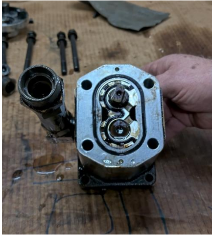
Figura 28. Engranajes y cuerpo de la bomba
