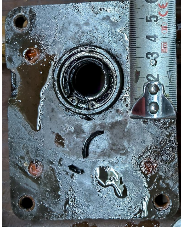
Figura 32. Detalle del deterioro del sello del eje motriz en la bomba número 1
