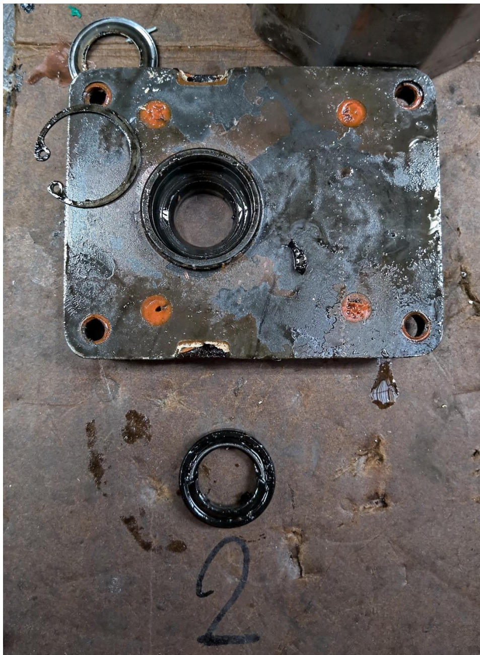
Figura 33. Detalle del deterioro de la junta de la bomba número 2
