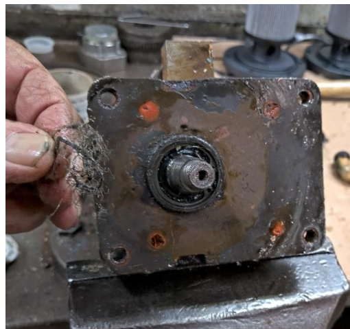
Figura 27. Placa con orificio y eje motriz
