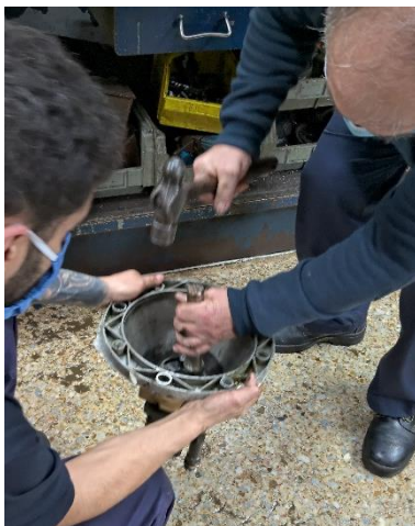
Figura 26. Desmontaje bomba número 1
