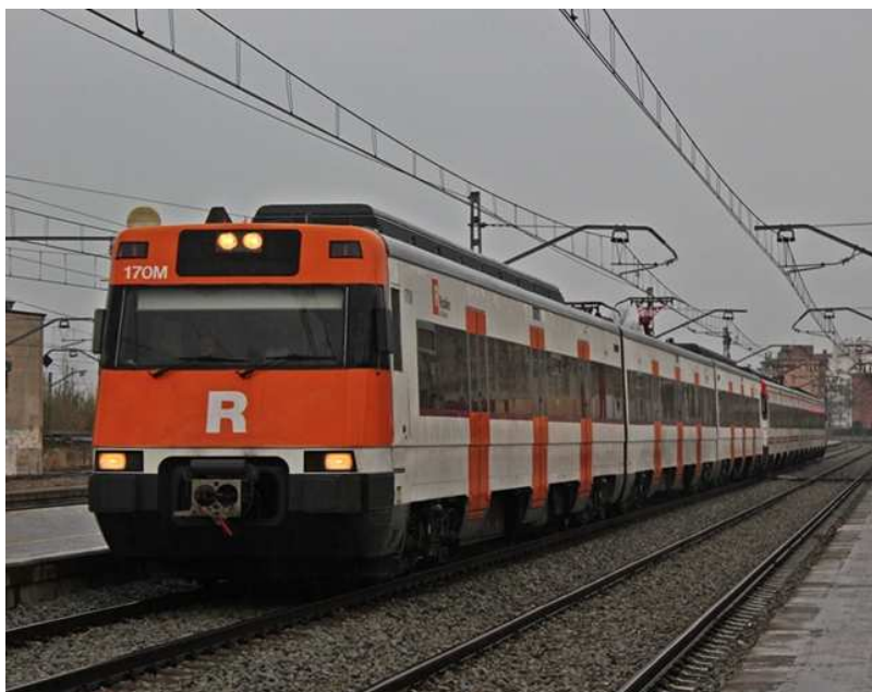
Figura 4: Unidad autopropulsada de la serie 447
