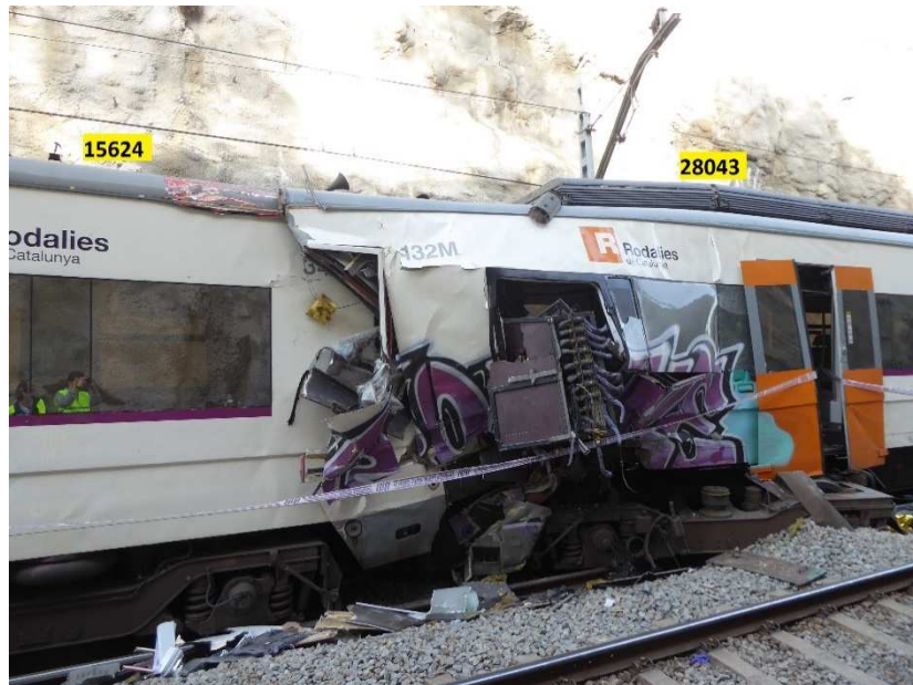
Figura 8: Estado en el que quedaron las cabezas de los dos trenes tras la colisión
