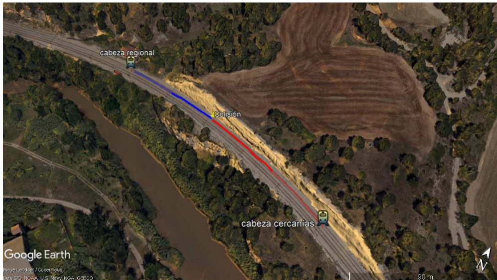
Figura 29: Croquis de las posiciones de los trenes 15624 y 28043 en el momento en el que llegan a verse, antes de la colisión (fuente: GoogleEarth)
