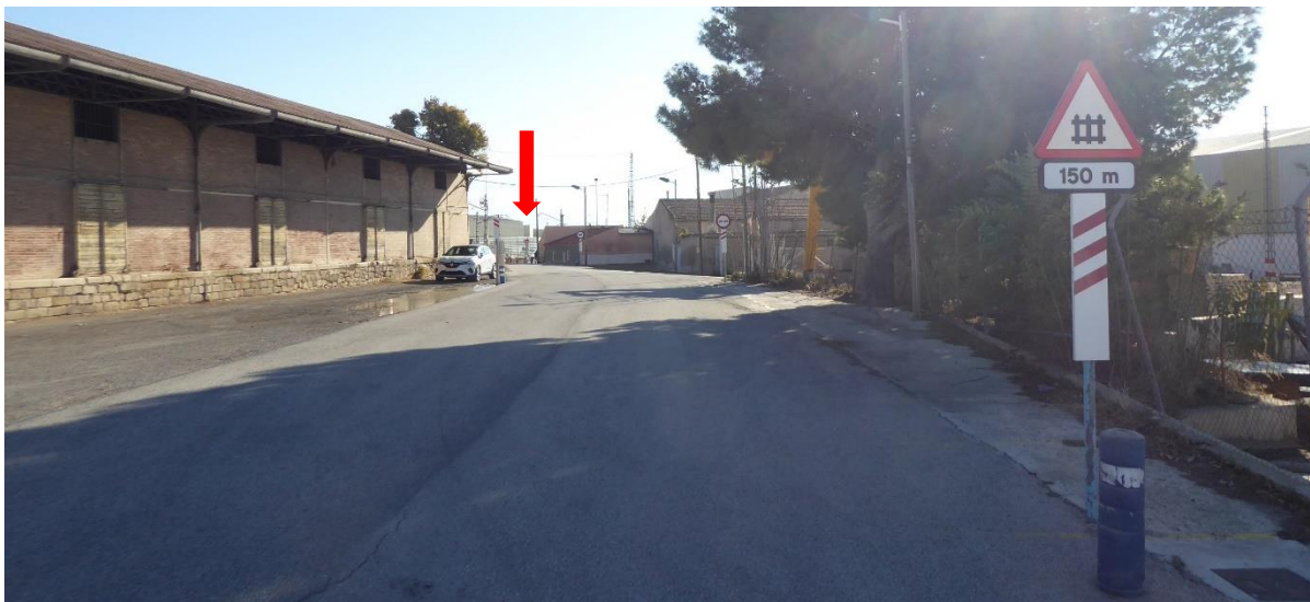
Figura 11: Señalización del paso a nivel desde la señal de proximidad a 150 m. La señal luminosa se ve a distancia sin dificultad (la posición del sol en la foto no corresponde con la del momento del accidente).
