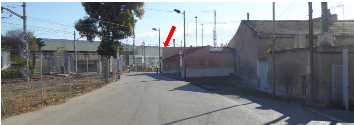
Figura 14: Señalización del paso a nivel entre las señales de proximidad a 100 m y 50 m. La visión del foco de la señal luminosa puede verse ocultada por el poste de alumbrado o la esquina de la casa.
