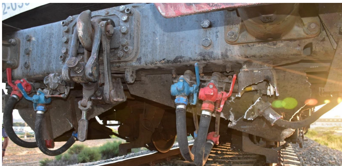
Figura 6: Daños en la cabecera del tren.
