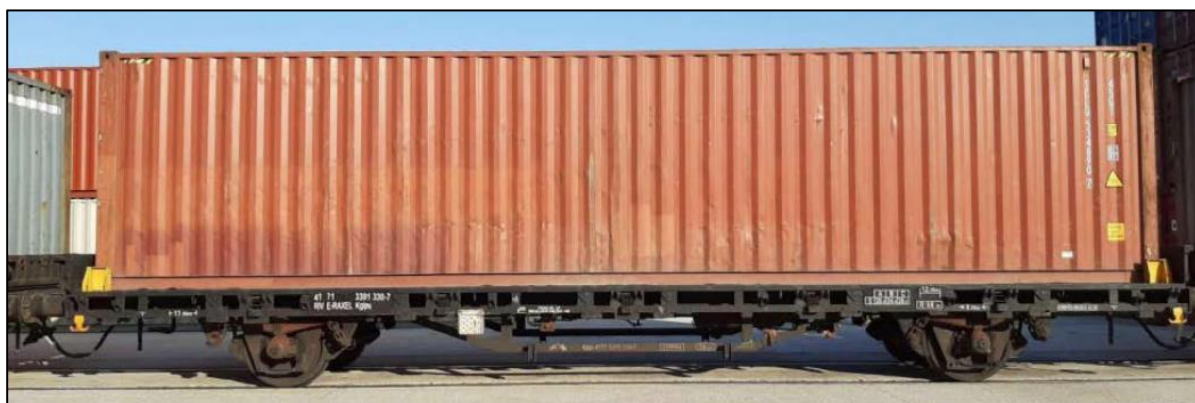
Figura 4: Vista de un contenedor HC de 40 pies montado sobre un vagón Kglps.
