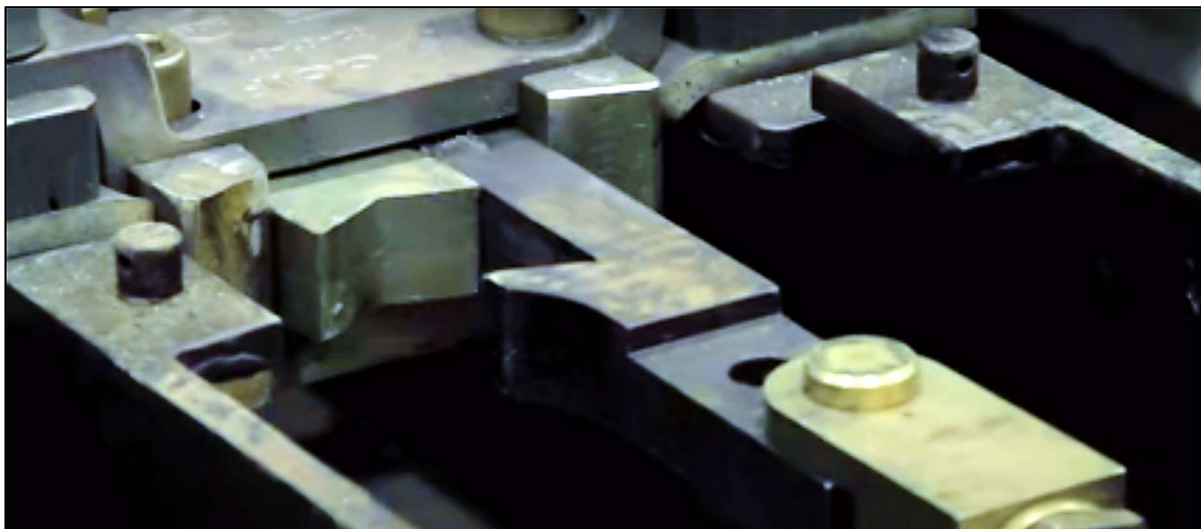
Figura 10: Vista de la entalla del barrón que aloja la biela en el momento que entra en la caja del cerrojo.
