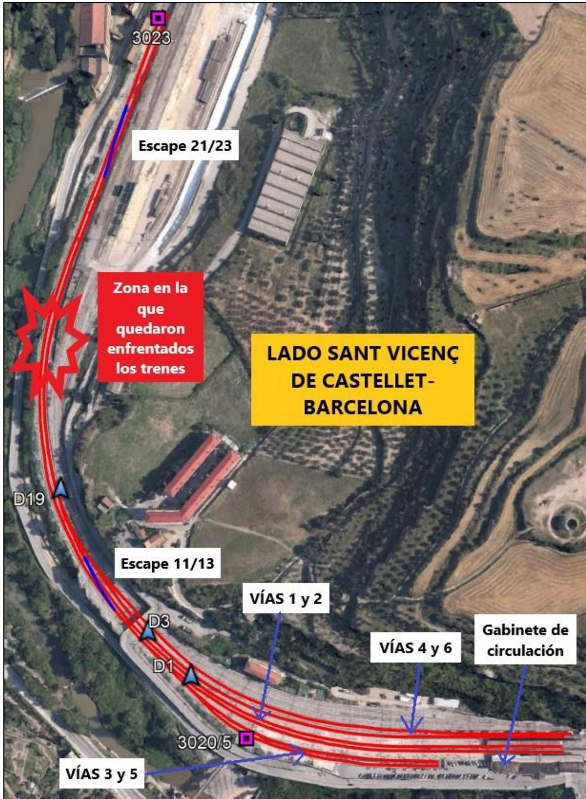
*Imagen 5* Detalle de los principales desvíos, escapes, señales de la estación de Manresa en el lado de Sant Vicenç de Castellet
