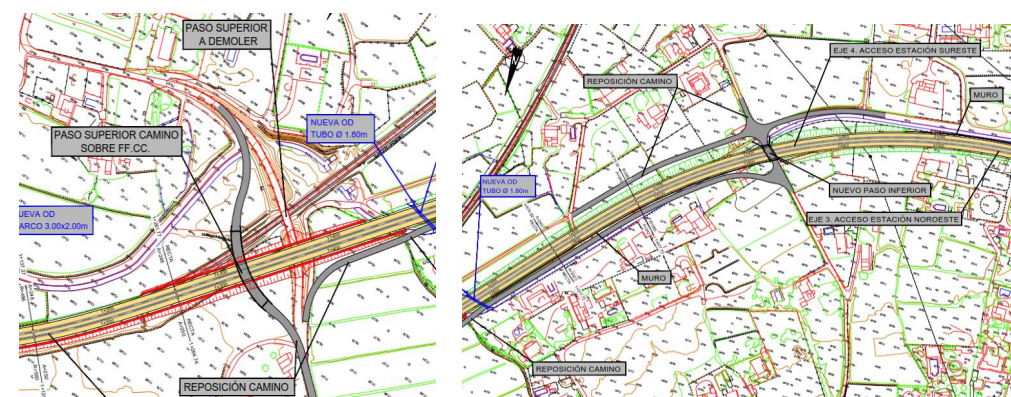
FIGURA 47. REPOSICIÓN DE CAMINOS Y ACCESOS A FINCAS. ENTRE LOS PP.KK. 1+330 Y 1+950
