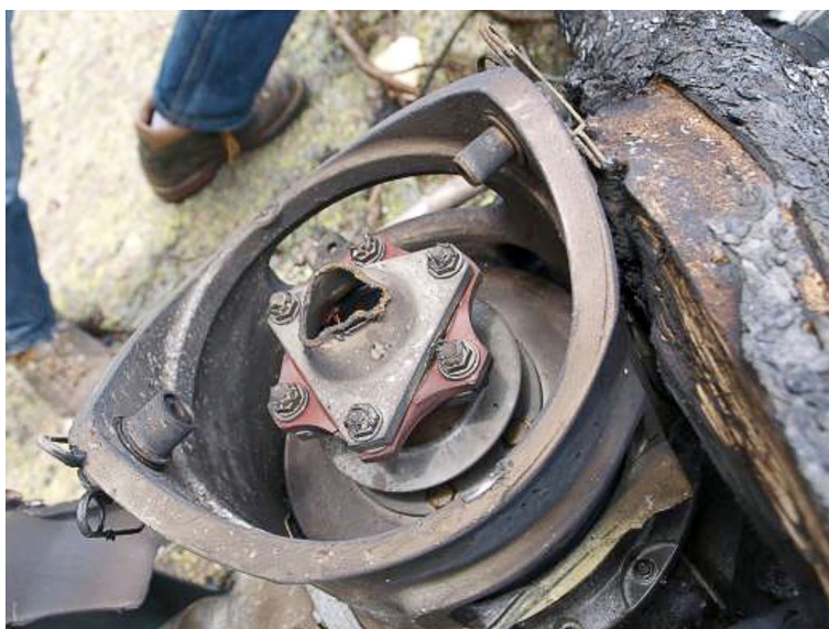
Figura 10. Rotura de la transmisión principal en el lado de la BTP
