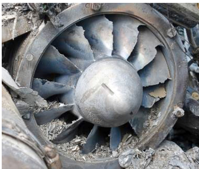
Figura 11. Daños en los álabes
