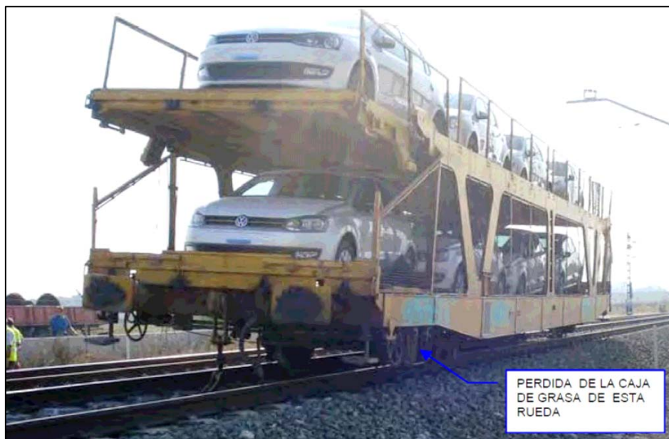
Vista lado derecho, en el sentido de la marcha del vagón descarrilado. (Fuente Adif)
