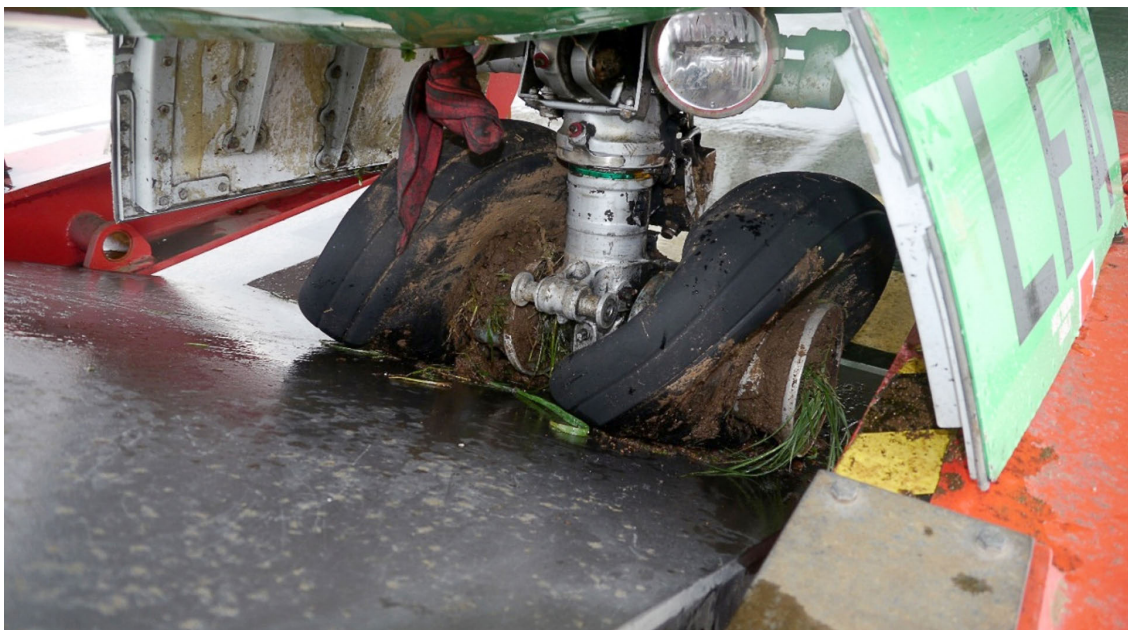
Figura 2. Detalle de estado de rueda de morro
