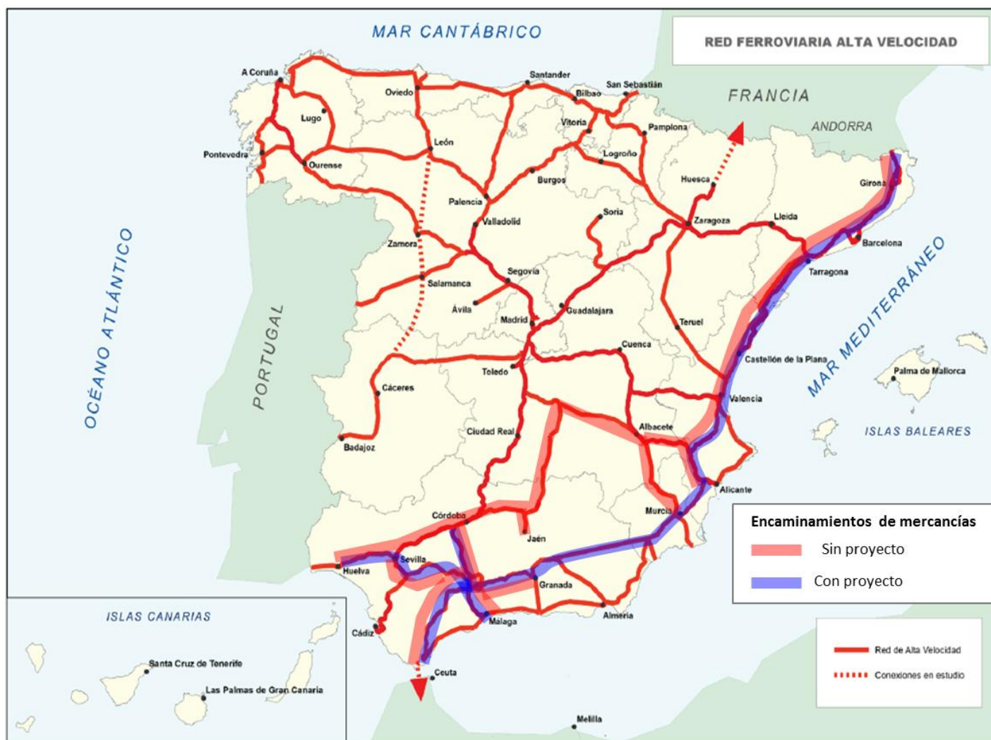
Figura 39. Encaminamiento de las mercancías por la red ferroviaria de Alta Velocidad planificada en el PITVI 2012-2024. Escenario PITVI
