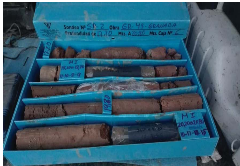
Foto de testigo de sondeo. Sondeo 2, Caja 6.
