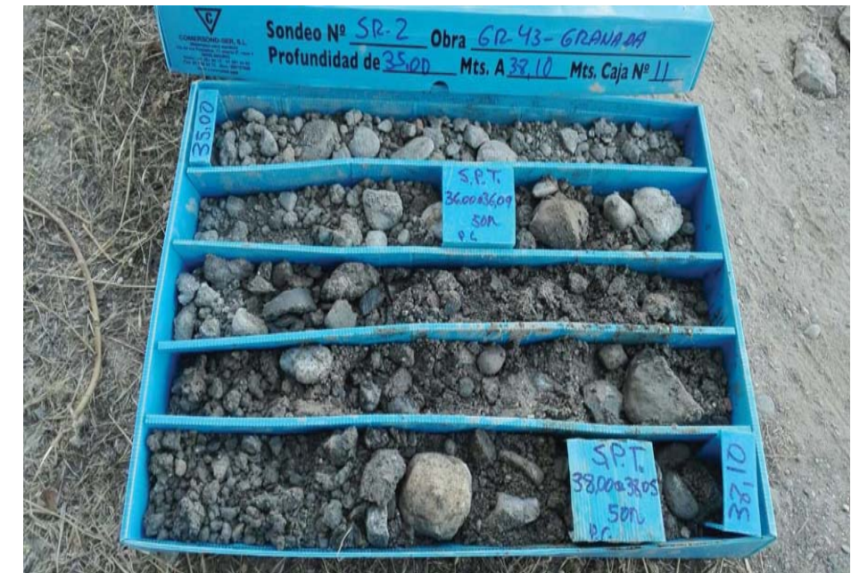
Foto de testigo de sondeo. Sondeo 2, Caja 11.
