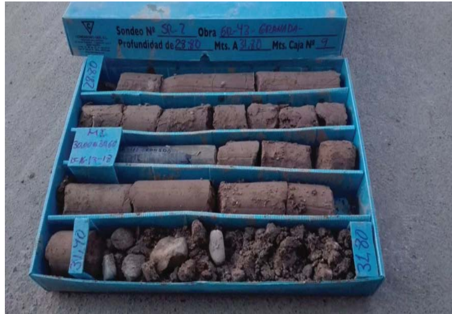
Foto de testigo de sondeo. Sondeo 2, Caja 9.
