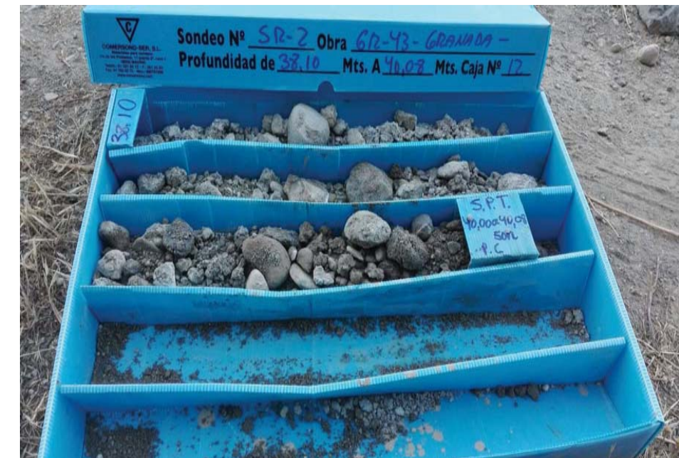
Foto de testigo de sondeo. Sondeo 2, Caja 12.
