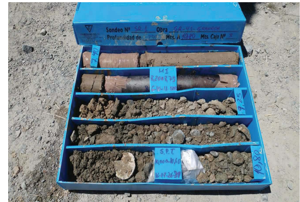
Foto de testigo de sondeo. Sondeo 1, Caja 3.
