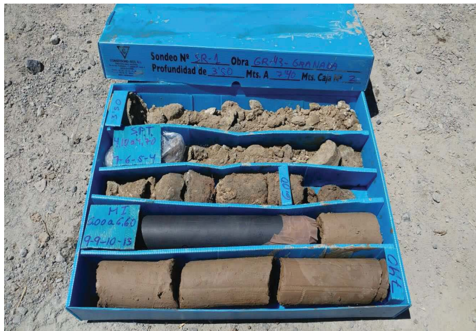
Foto de testigo de sondeo. Sondeo 1, Caja 2.
