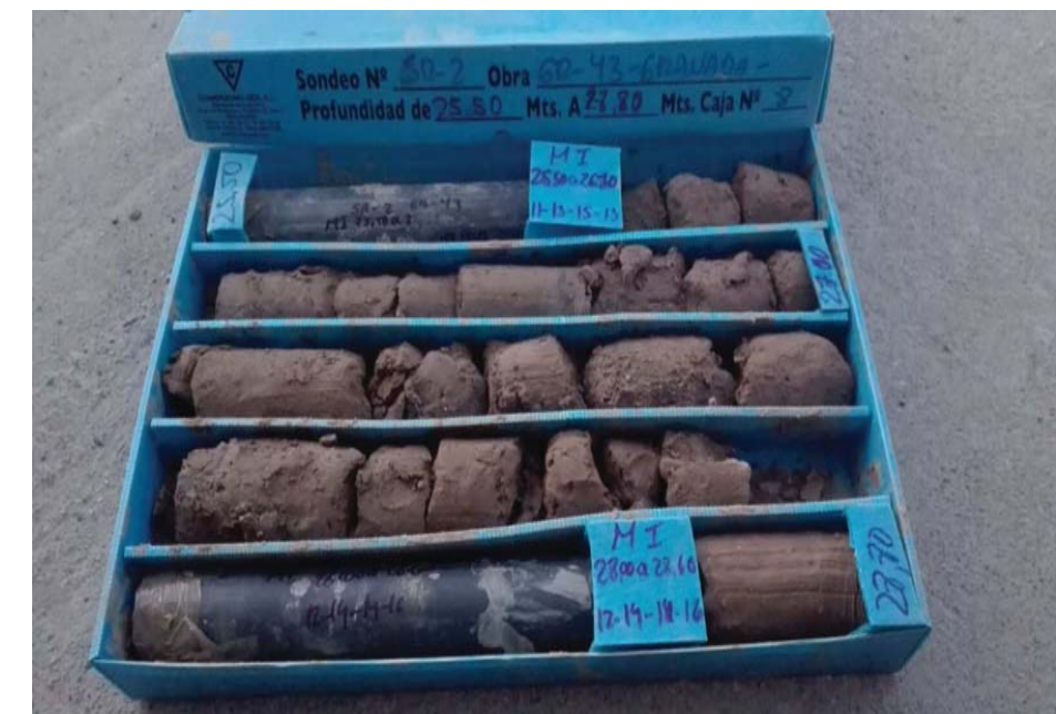
Foto de testigo de sondeo. Sondeo 2, Caja 8.
