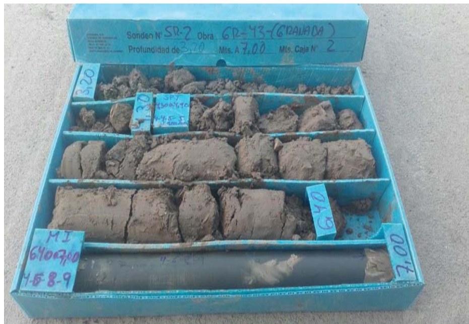
Foto de testigo de sondeo. Sondeo 2, Caja 2.
