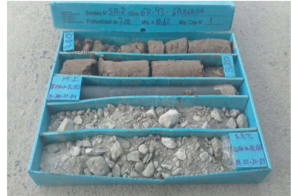
Foto de testigo de sondeo. Sondeo 2, Caja 3.
