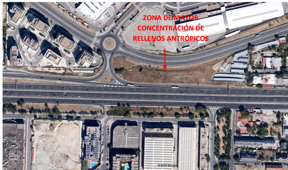
Figura 5. Imagen aérea de la zona del P.K. 0+900 del Eje 1, en la que se han observado los mayores espesores de relleno antrópico sin compactar
