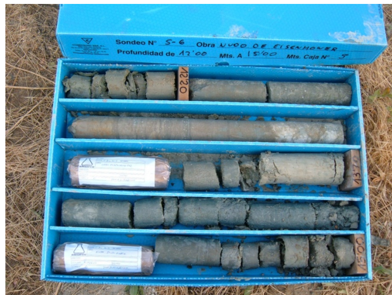
Figura 2. Aspecto de la unidad de arcillas verdesas en el sondeo S-6 realizado en la campaña actual
