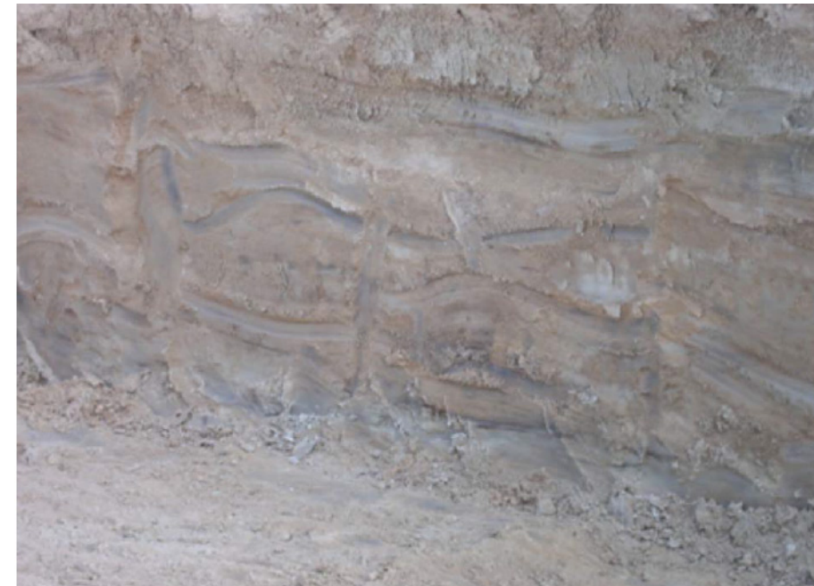
Figura 1. Detalle de las arenas finas arcósicas de la unidad Arenas Tosquizas (foto extraída del P.C. “Acceso a Madrid. Plataformas Reservadas para el Transporte Público, vías de servicio y Actuaciones Complementarias. P.K. 5,3 al 24,5. Tramo: Arturo Soria –Alcalá de Henares” (Prointec, 2008).
