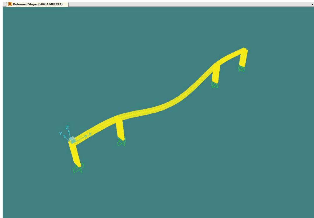
Ilustración 4. Deformada Carga muerta
