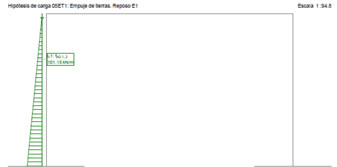
Modelo de pórtico plano. Estructura E-1. Empuje de tierras al reposo E1
