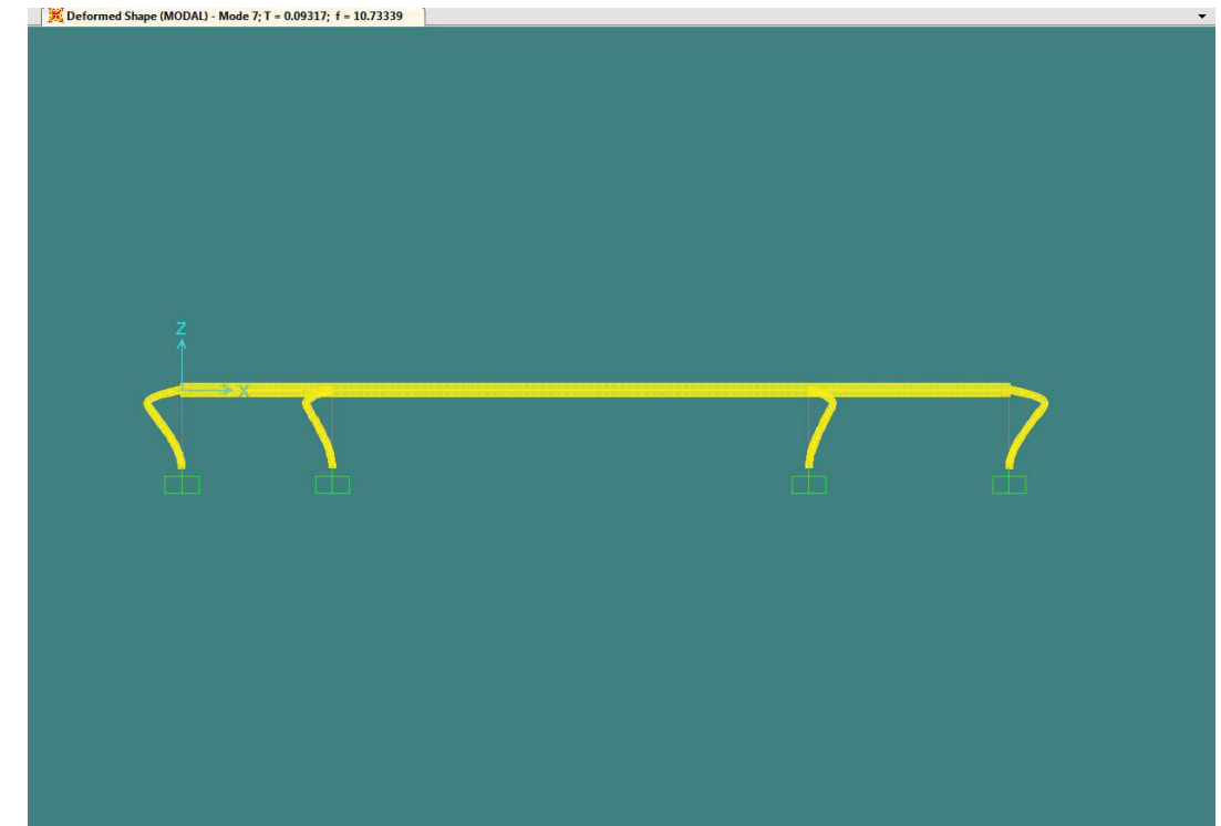
Ilustración 22. Deformada MODAL 7. Alzado
