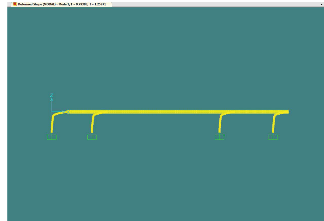
Ilustración 10. Deformada MODAL 1. Alzado
