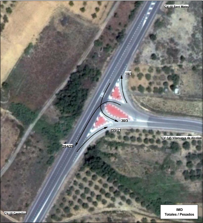
AF 3. Intersección de CV-10 con CV-145 (IMD)
