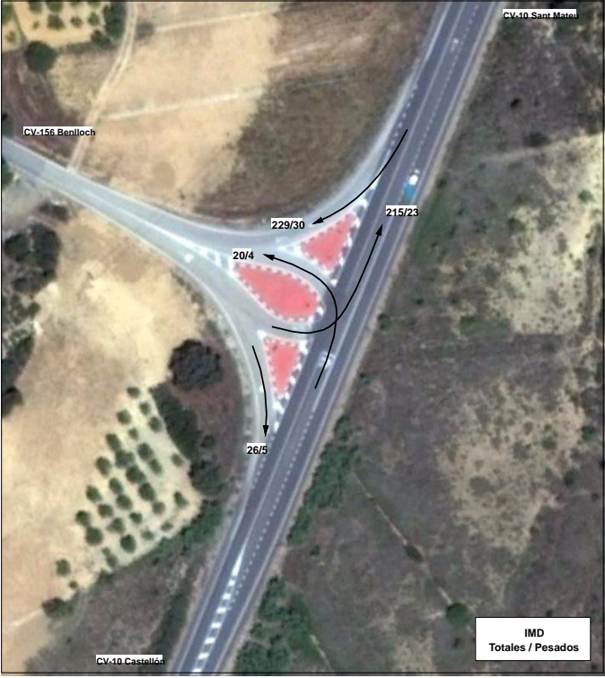
AF 2. Intersección de CV-10 con CV-156 (IMD)
