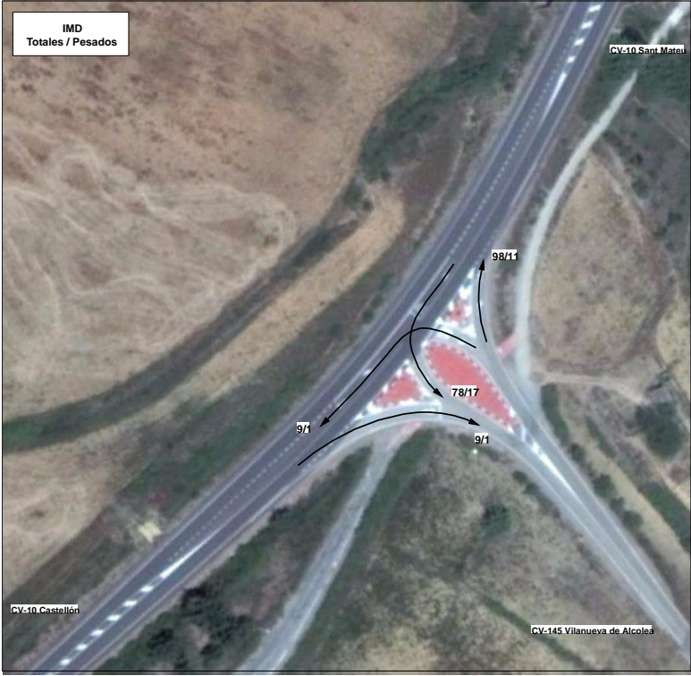
AF 4. Intersección de CV-10 con CV-1440. (IMD)
