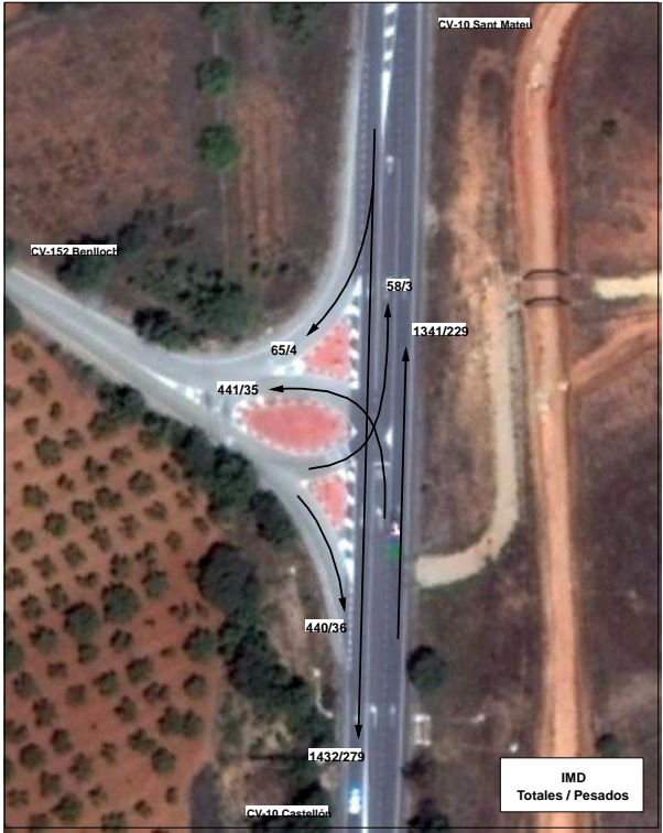
AF 1. Intersección de CV-10 con CV-152 (IMD)
