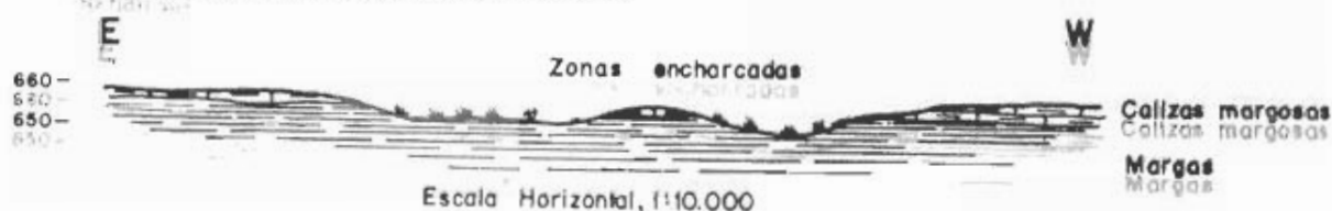
Enchercamientos consecuencia del deficiente drenaje de las margas, al S. de Villamayor de Calatrava.
