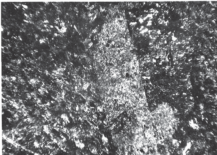
Foto 29.— Fenocristal de plagioclasa en un típico pórfido, E-15. C-534-4.
