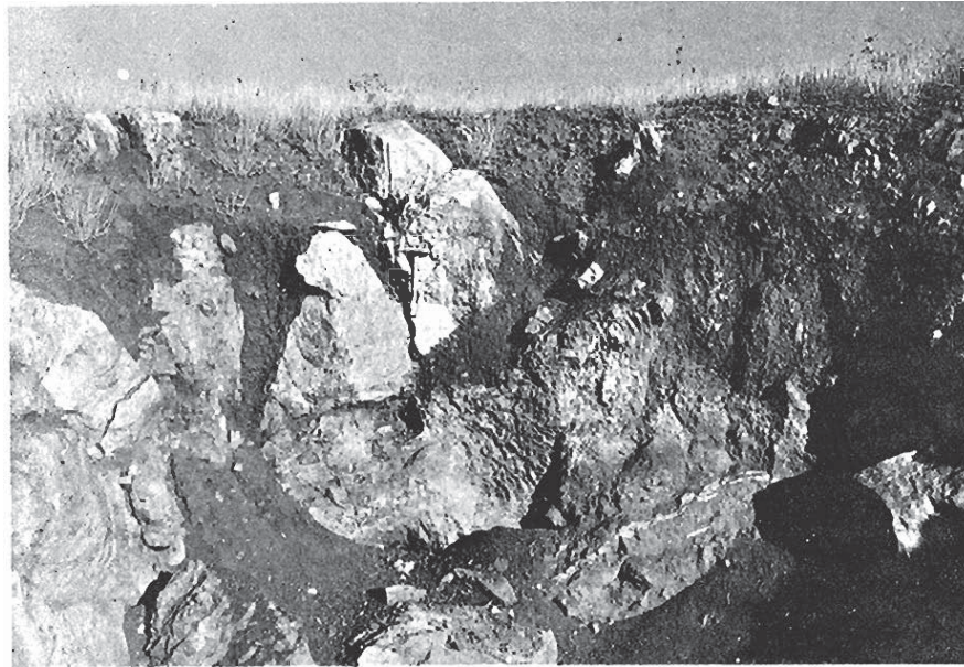
Foto 16.— Calicata en roca de silicato cálcico del cerro de S. Eugenio, que constituye un buen yacimiento a explotar, E-20. C-509-3.
