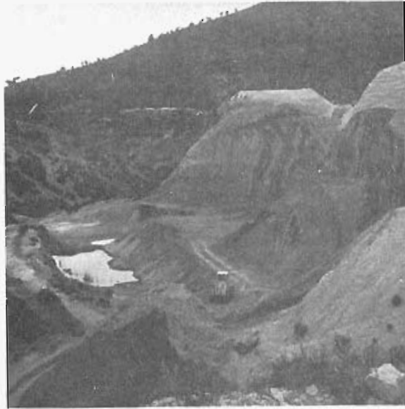
Foto 29.—Explotación activa de las arcillas del grupo 20a, origen, junto con otras del mismo tipo, de encharcamientos temporales. (Cuadrante 871-1).
