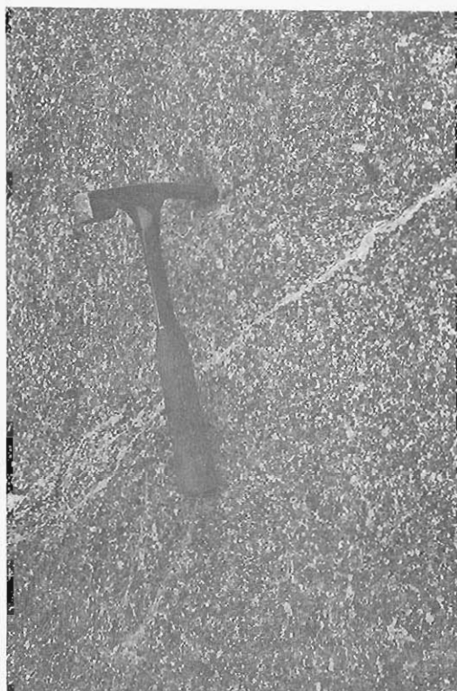
Foto 8. Detalle de los granitos del Ulla. Se observa un tamaño de grano grueso y en el centro de la fotografía una pequeña diaclasa.
