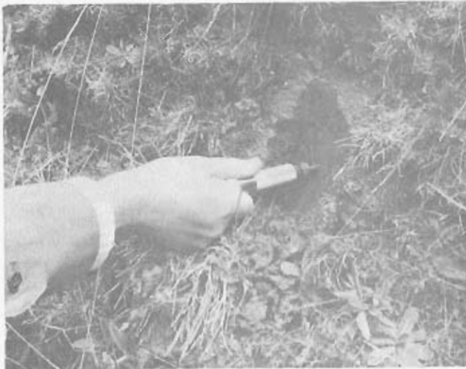
Foto 44.— Ensayo de penetración "in situ" con "Soil-test penetrometer" sobre las aleuritas del grupo 231a'. (Cuadrante 134-4).
