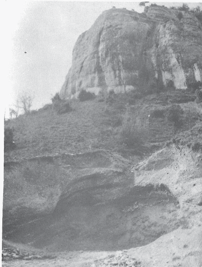
Foto 70.— Coluvial C1 utilizado como préstamo para terraplenes. (Cuadrante 109-4).
