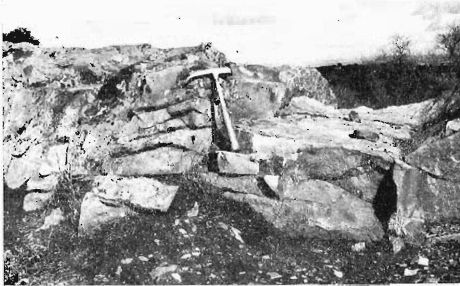
Fot. 14. Detalle de la cuarcita armoricana muy fracturada y diaclasada.
