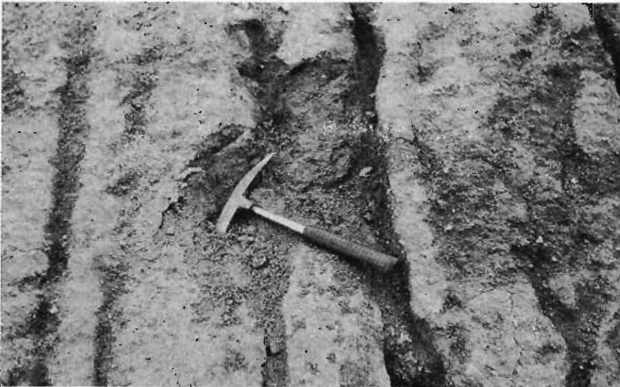
Fot. 18. Detalle de las areniscas limo-arcillosas del Mioceno de Almaraz en la Carretera N-V - Madrid-Badajoz, P. K. 197.
