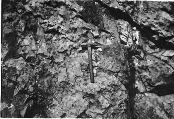
Foto 24.— Vista parcial de un talud vertical tallado en el grupo 312d en el que se aprecia la fuerte cementación de los clastos. (Cuadrante 291—4)
