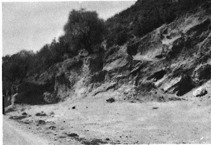
Foto 116.— Coluvial tipo C-7 utilizado como préstamo en las inmediaciones de Vilanova de Meyá (Cuadrante 328-4).
