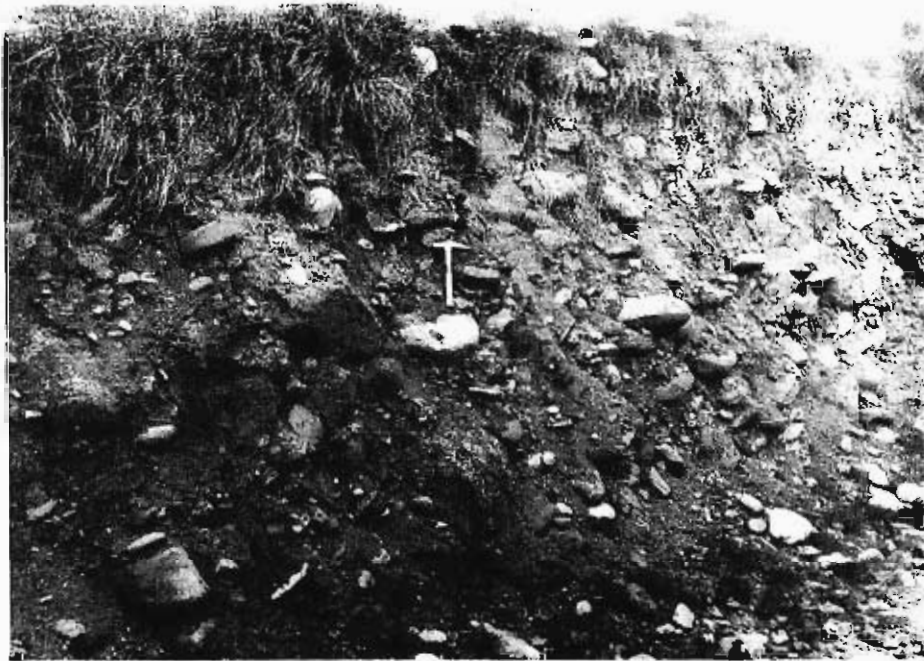
Foto 13.- Aspecto del material T1 mostrando los altos índices de redondez y esfericidad de los gruesos. Foto tomada en la carretera local de Escalona a Puértolas.
