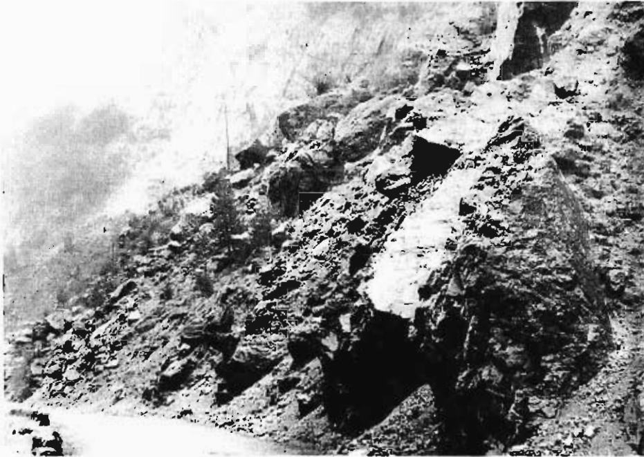
Foto 24.— Aspecto de los materiales del grupo C5, donde se aprecia el gran tamaño que pueden alcanzar algunos de los bloques. — Fotografía tomada en las cercanías del embalse de Plan.
