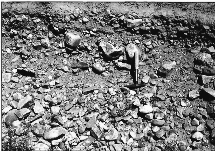
Figura 3.9.- Detalle de las gravas cuarcíticas de los depósitos de terraza (formación T1), en donde puede observarse la forma y la granulometría de las mismas. Río Agueda, en las proximidades de Ciudad-Rodrigo (Hoja 525-1).
