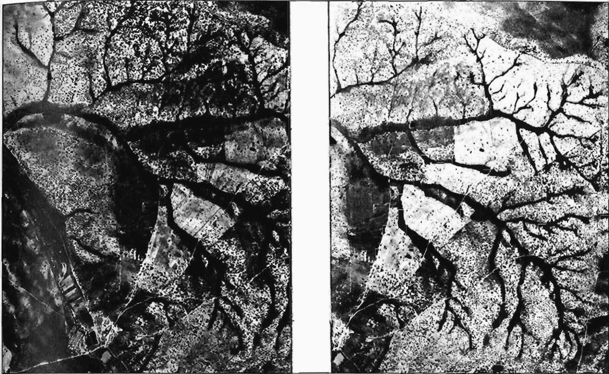
Figura 3.3.- Visión estereoscópica de una típica red de drenaje dendrítica, desarrollada por la erosión de materiales detríticos horizontales, en las proximidades de la alquería de Paradinas de Abajo. Fragmento obtenido de los fotogramas n OS 4412 y 4413 (vuelo americano) de la Hoja 501-3.
