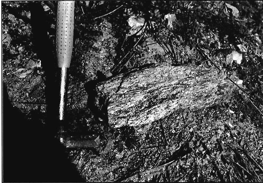
Figura 3.36.- Muestra de micacita en la que pueden verse las recrystalizaciones biotíticas (color oscuro) y moscovíticas (color claro). Proximidades de la alquería de Valdelama (Hoja 477-3).
