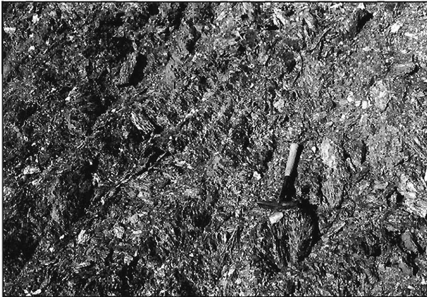
Figura 3.38.- Aspecto de las micacitas alteradas en un pequeño talud realizado en la carretera de Aldehuela de la Bóveda a Garcirrey (Hoja 477-3).
