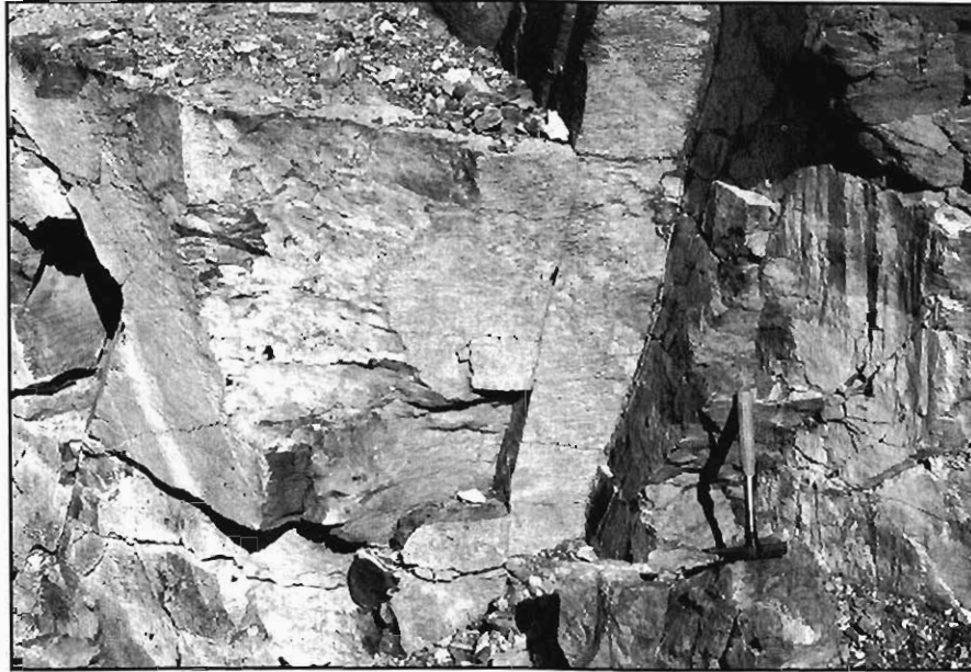
Figura 3.19.- Aspecto de las cuarzo-filitas del grupo (111b), en las inmediaciones de la localidad de Golpejas (Hoja 477-1). Puede observarse la disgregación en bloques que produce el diaclasado, así como una cierta laminación originada por una esquistosidad poco penetrativa.
