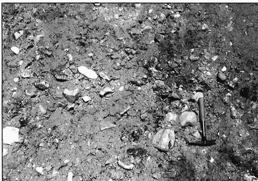
Figura 3.12.- Detalle de los conglomerados del grupo (321), en el que se observa su granulometría y su escasa consolidación. Proximidades de Aldehuela de la Bóveda (Hoja 477-3).
