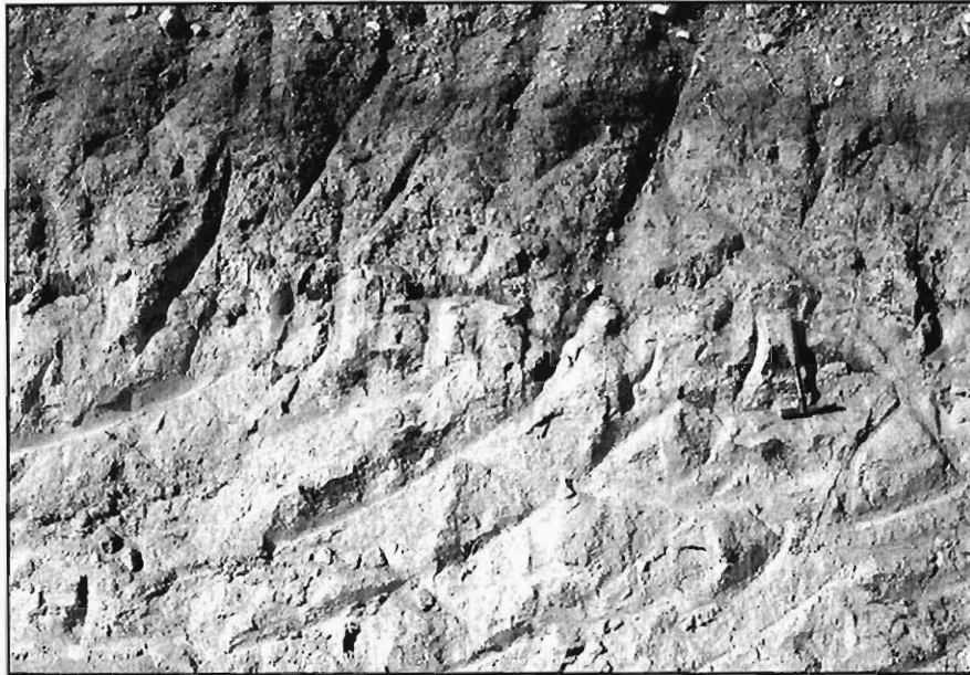
Fig. 3.27.- Detalle del jabre que forma el grupo (V1) en una pequeña excavación en las proximidades de la localidad de Fuentes de Oñoro (Hoja 525-4). Las huellas dejadas en el material por una excavadora indican la consistencia del mismo. El nivel superior es un horizonte rubefactado.
