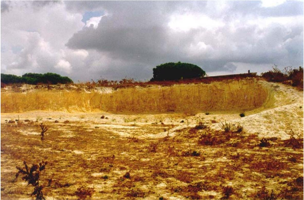
*Figura 3.15. Pequeña explotación en las calizas del grupo (322b), localizada al sur de los LLanos de Guerra. Obsérvese el aspecto masivo de los materiales (Hoja:1069-4).*
