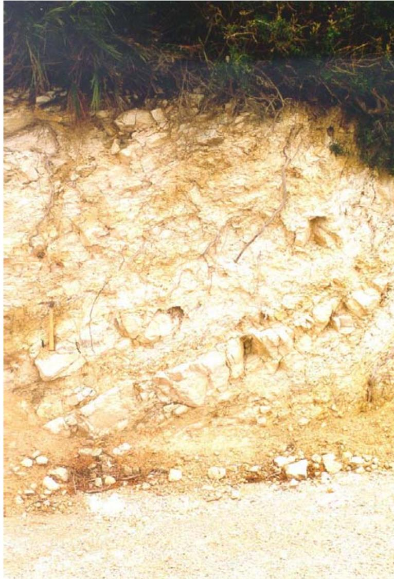
*Figura 3.44. Detalle de las margocalizas y margas del grupo (231c), en la pista que sube a la cantera de El Berrueco. Los niveles superficiales se hallan intensamente alterados.*
