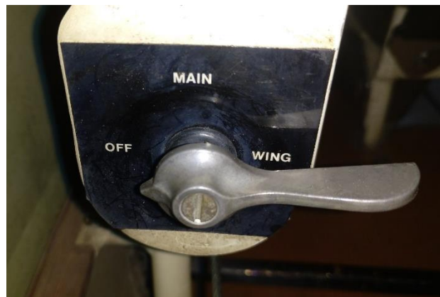
Figura 5. Fotografía de la llave selectora de combustible (en la posición cerrada)
