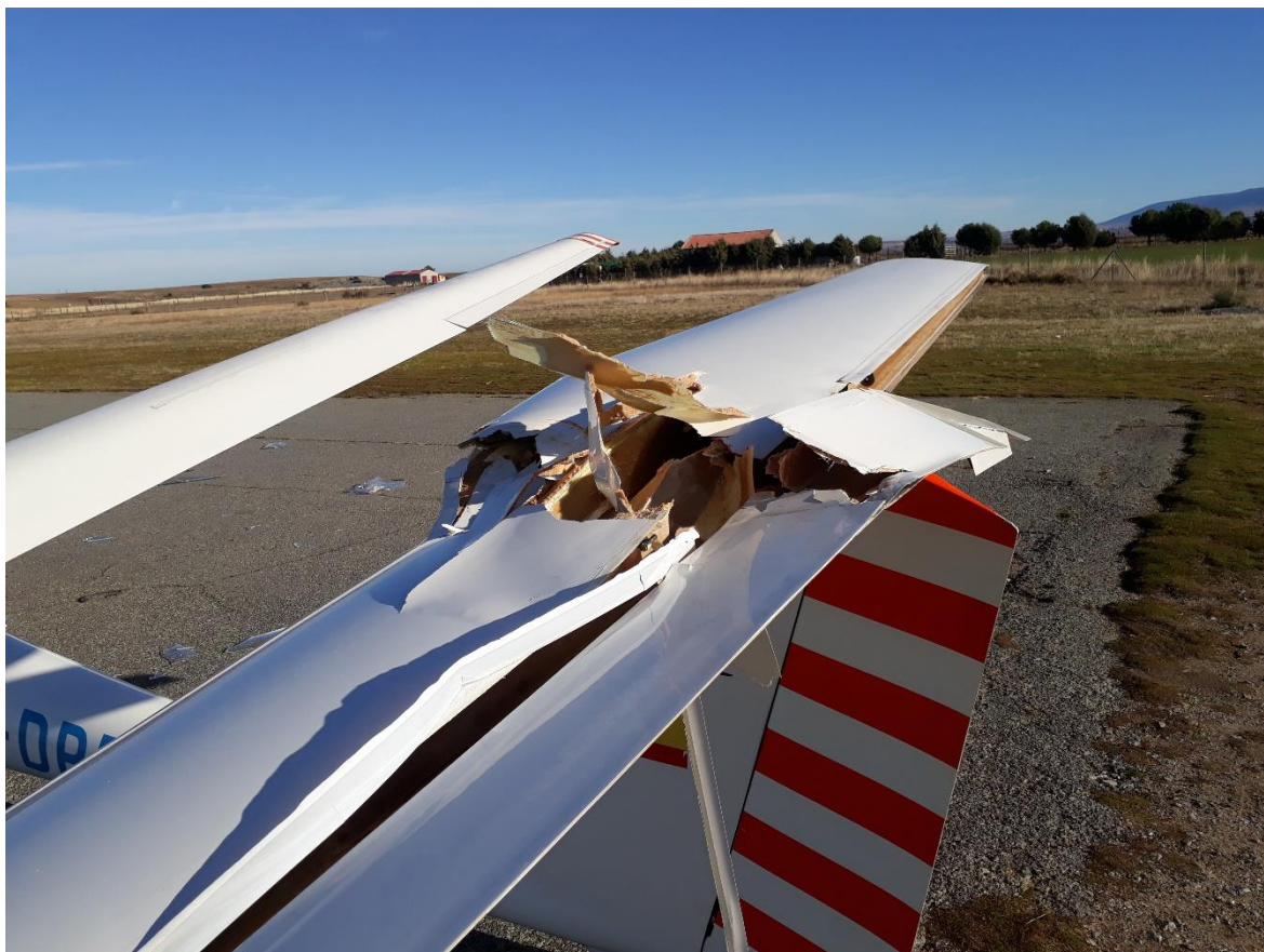
Figura nº 1.- Daños en el empenaje de cola, velero EC-DPE
