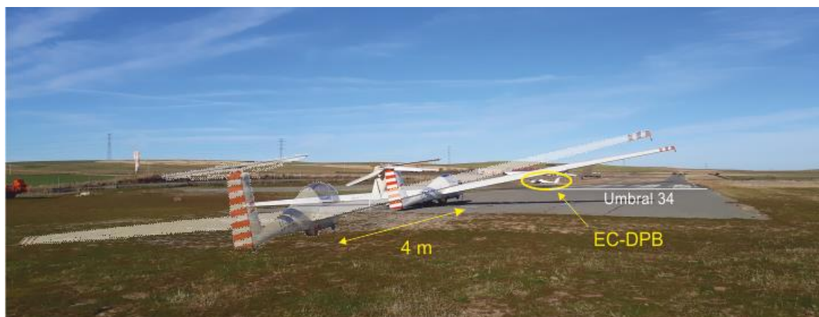
Figura/croquis nº 4.- Posición inicial y tras el impacto EC-DPE y relativa respecto a la pista. Incluye la posición final del EC-DPB
