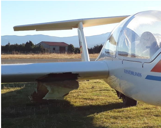
Figura nº 2.- Daño en el intradós plano derecho EC-DPB
