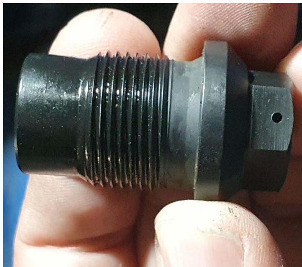
Figura 9. Tornillo de registro de la bomba /Spill plug
