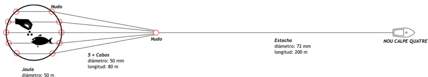
Figura 9. Esquema de la línea de remolque (parte de la jaula acuícola).
