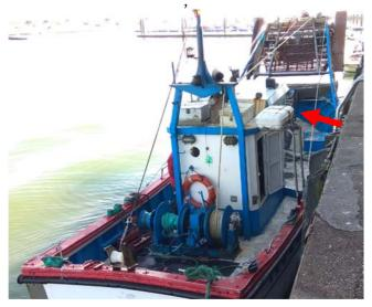
Figura 11. Emplazamiento de la balsa salvavidas
