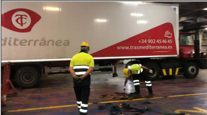
7. Plataforma en posición. El conductor frena la cabeza tractora. Los tripulantes cogen material de trincaje
