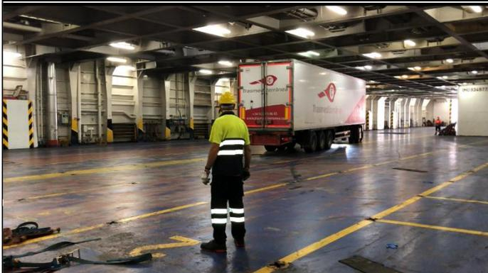
5. El remolque cabeza-plataforma se detiene. El conductor busca enfilar la calle donde debe colocar la plataforma. Pasa de "tirando" a "empujando".
