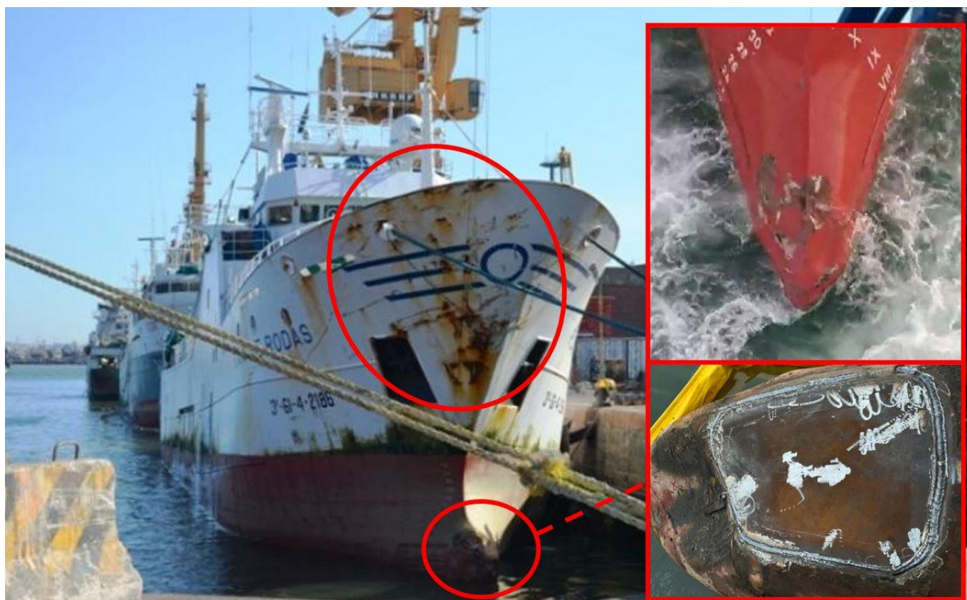
Figura 4. Estado del buque PLAYA DE RODAS en el puerto de Montevideo, el 19 de mayo de 2020. Detalle de los daños en el bulbo y de su reparación.
