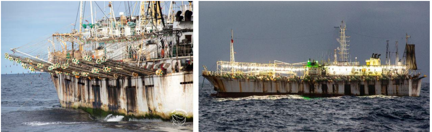
Figura 9. Buque potero con el arte desplegado (Izda.) y las luces empleadas para atraer a los calamares (Dcha.) (Fuente: Simon Ager / SEA SHEPHERD)
