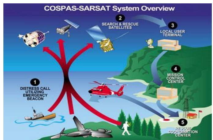
Figura 11. Esquema del sistema COSPAR-SARSAT
