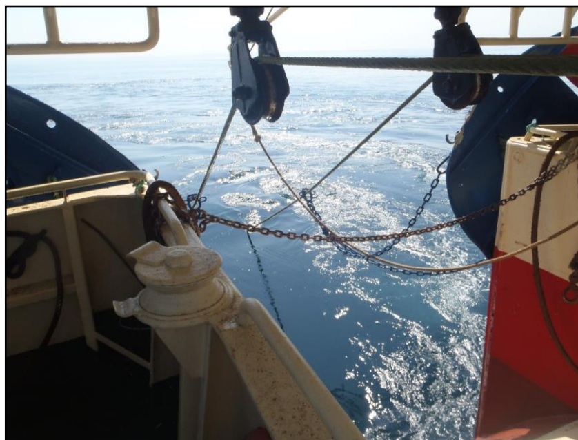
Détail de la patte d'oie des bras / Detail of the braces bridle
