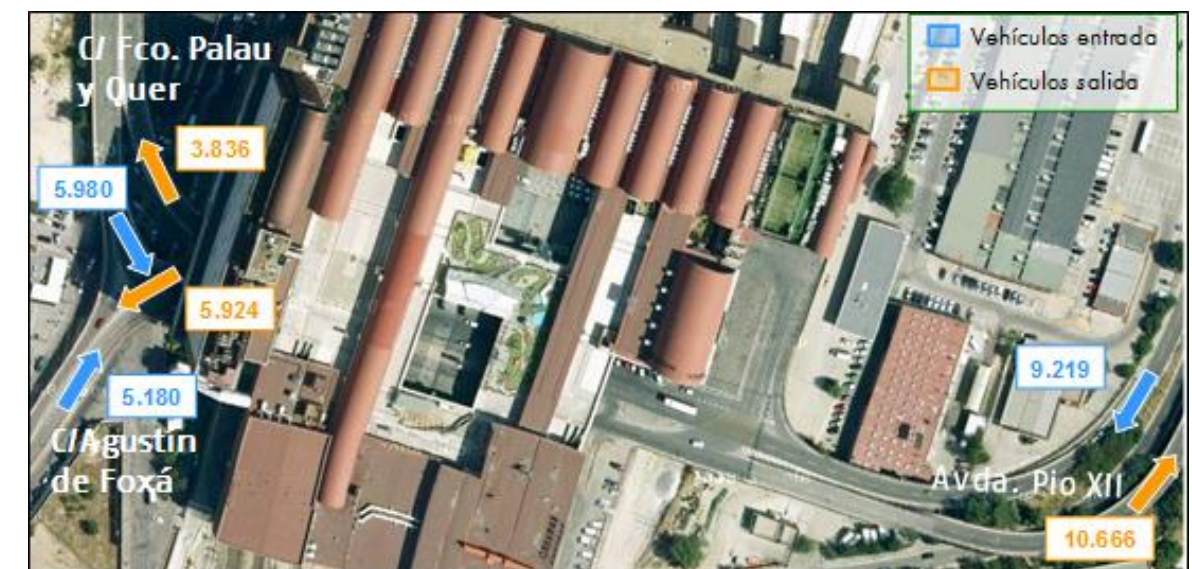
Estructura de tráfico de entrada y salida a la estación
