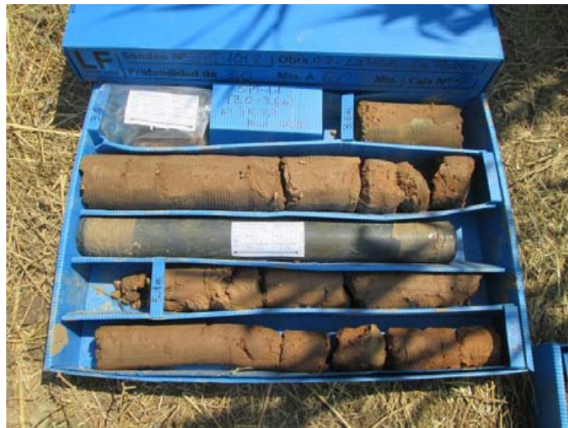
Fotografía 13. Aspecto depósitos de fondo de valle registrados en el sondeo SPI-101.2 de 3.00 a 6.00 m de profundidad
