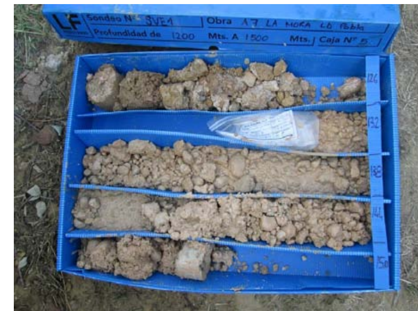
Fotografía 11. Aspecto conglomerado de terraza aluvial perforado en sondeo SV-E1.
