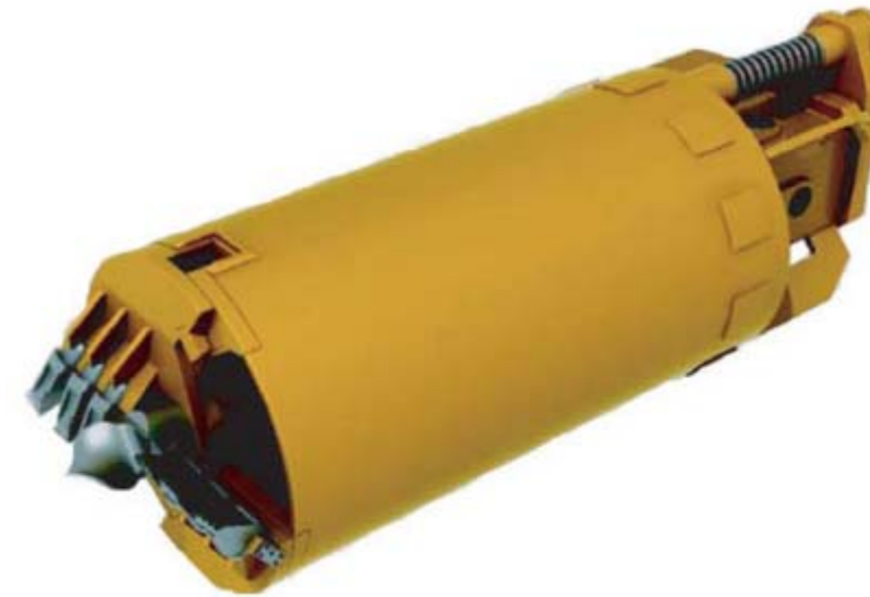
Ejemplo de cazo o bucket utilizado para perforar pilotes.
