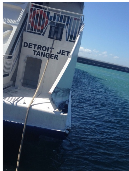
Figura 5. Daños en el DETROIT JET
