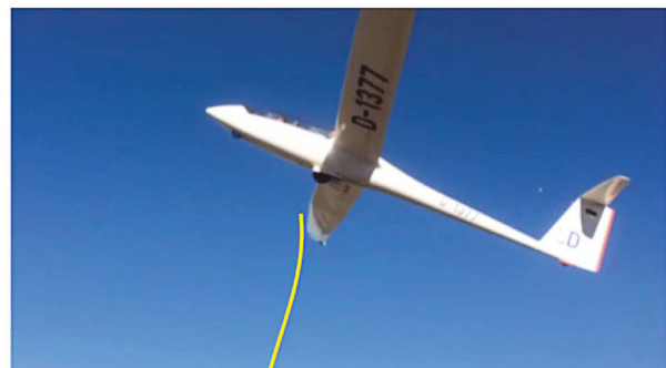
Ángulo de 90° entre cable de tracción y eje longitudinal del avión con suelta automática del cable por geometría
