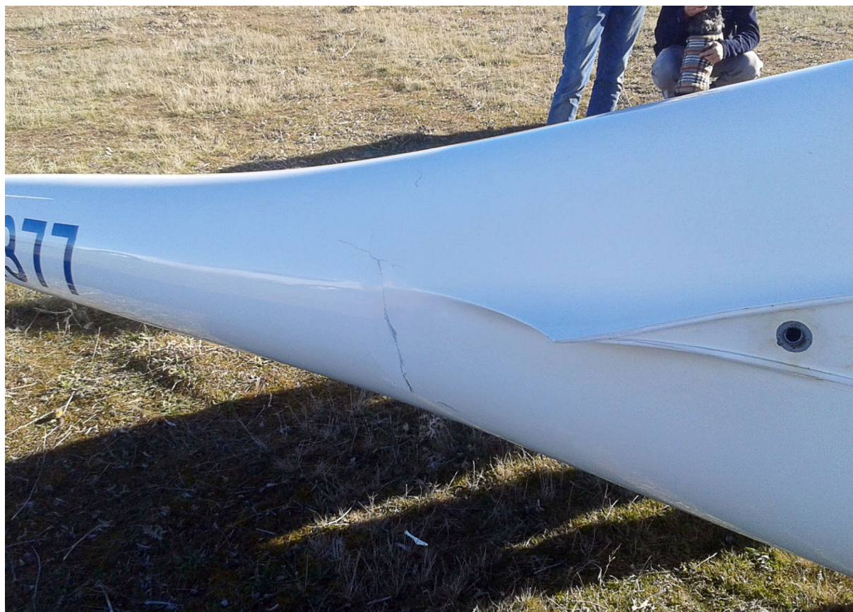
Figura 3. Localización de fisura en el fuselaje
