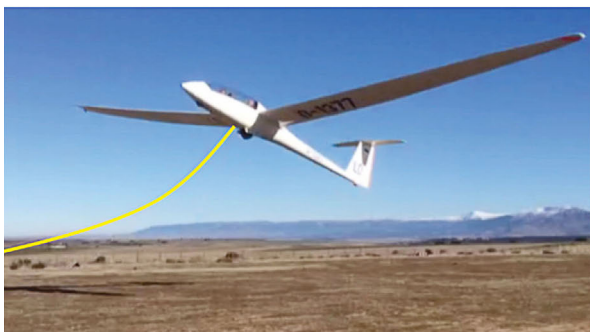
Ascenso con excesivo ángulo sin remolcado efectivo
