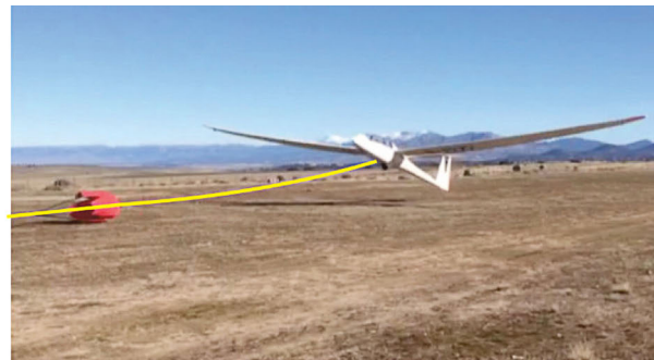
Ascenso inicial prematuro con excesivo ángulo de encabritamiento Perdida de revoluciones del motor y cable destensado
