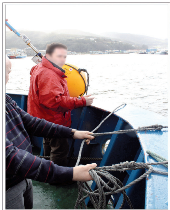
Figura 19. Maniobra de lanzamiento de boya
