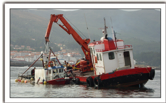
Figura 6. Reflotamiento de la embarcación FURACÁN.
