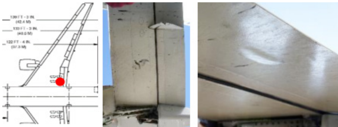
Figura 16. Daños en el flap del plano derecho
