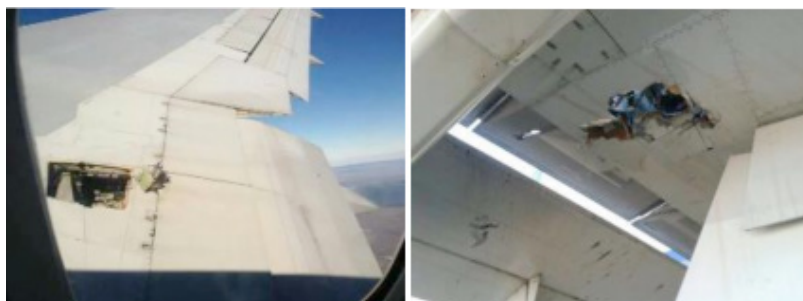
Figura 1. Fotografías de las roturas en extradós (hechas en vuelo)
