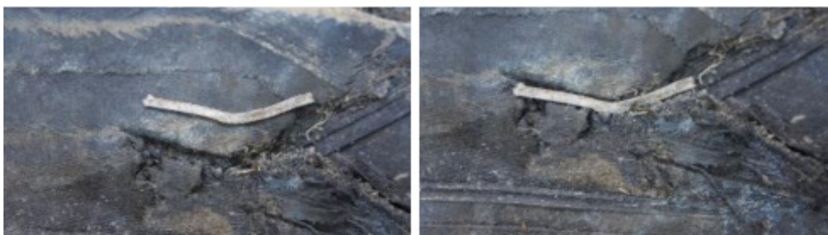
Figura 21. Pieza metálica encontrada en la pista 36 L y su encaje en el neumático
