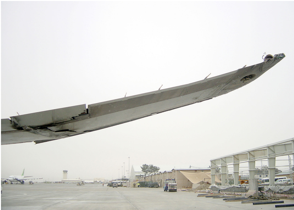
Figura 1. Vista trasera del plano derecho dañado
